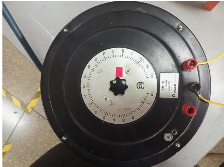
Partiendo de la fuente de energía que en este caso sería directamente desde el enchufe común de 120V se conecta en una salida el reóstato y conexión directa hacia las resistencias del evaporador, y en la otra salida el switch y conexión directa hacia las resistencias del evaporador.
