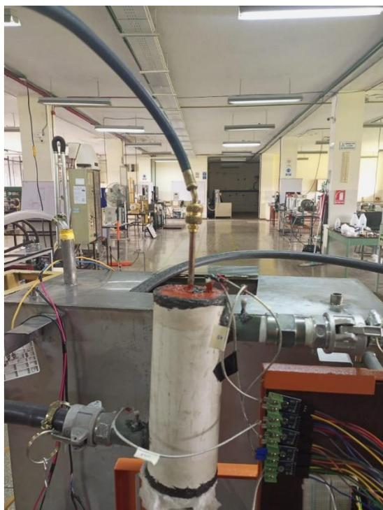
3) A continuación, se realiza la conexión eléctrica, desde la fuente hacia el reóstato y las resistencias para la variación de potencias.
