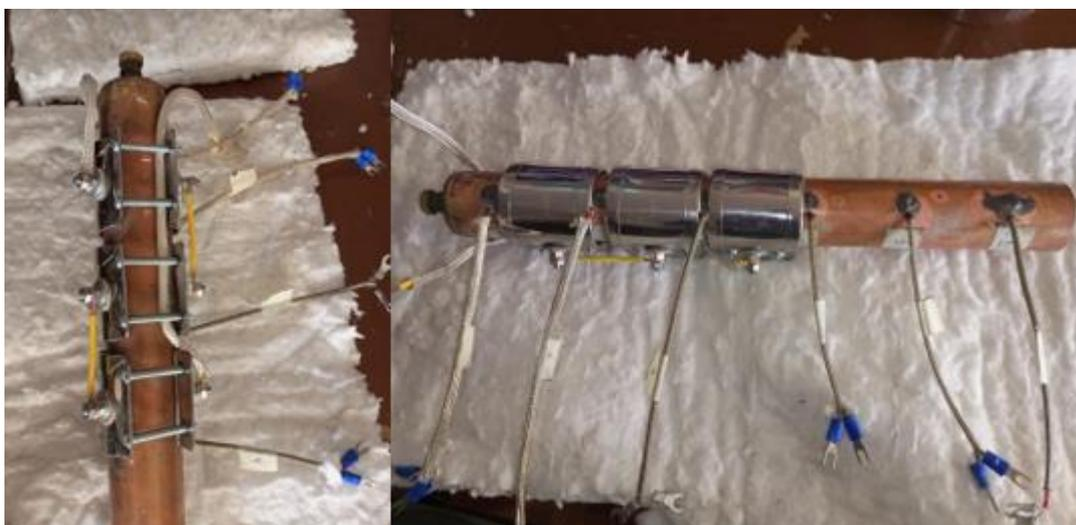
8) Para evitar la pérdida de calor por convección hacia el ambiente exterior, se cubre al evaporador y zona adiabática con lana aislante PET.
