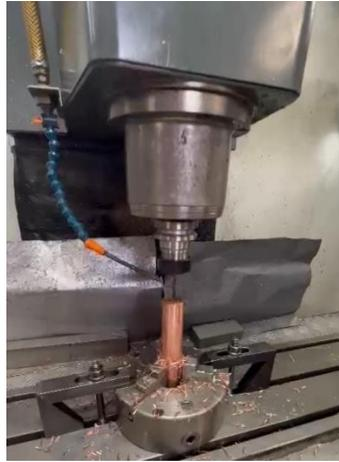
4) Completo el proceso de perforación se procede a realizar el roscado externo en cada uno de los condensadores.
