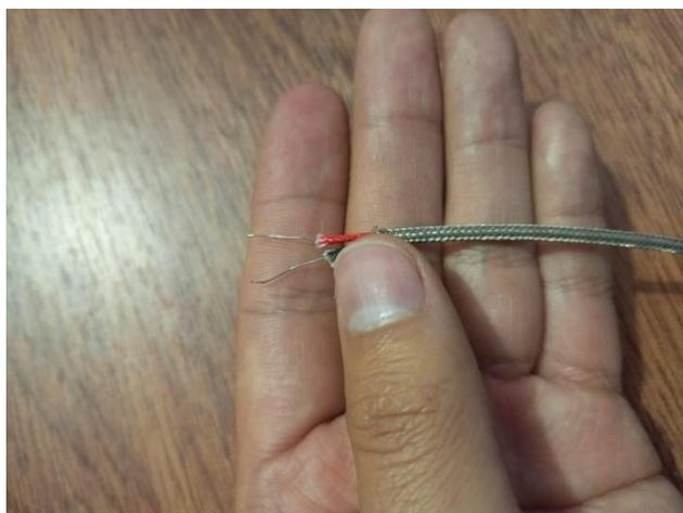
5) Como siguiente paso, se sueldan las termocuplas tipo K, para esto se utiliza soldadura blanda y estaño (con 60% de estaño y 38% de plomo) de diámetro 1mm.
