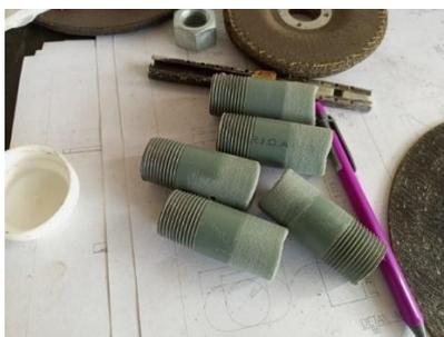
4) Se unen las tapas y las conexiones de entrada y salida de agua a los tubos con soldadura fría de marca PEGATANK, para lo cual es necesario obtener un perfil de anclaje SP2, el cual lo realizaremos manualmente con lija.
