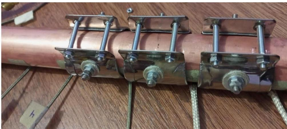
7) Colocadas las resistencias, a continuación, se procede a realizar la conexión eléctrica de las mismas.
