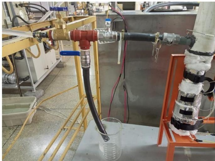
Donde se tiene una válvula de bola para abrir y cerrar el paso de agua hacia el intercambiador y otra válvula de bola para abrir y cerrar el paso de agua hacia el medidor de caudal, el caudal es regulado con la válvula de compuerta.
