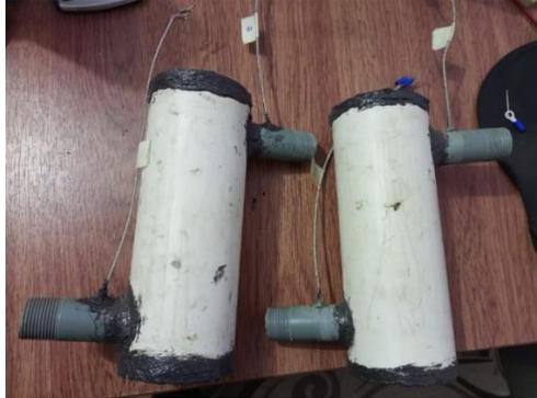
6) Como último paso se une al intercambiador de calor con el condensador mediante soldadura fría.
