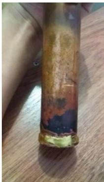
2) Seguidamente, se torneó para mantener la cilindridad del evaporador, realizamos una perforación en el centro de la tapa, de 0.03 m, en el cual soldaremos el tapón de ½" (para evacuación de fluido de trabajo) y a continuación soldaremos, se utilizó soldadura amarilla (bronce) y fundente.
