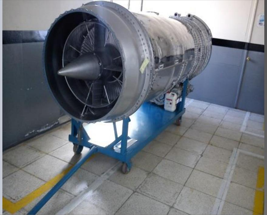
Como se puede observar en la imagen el ensamble final es equivalente al diseñado en el software, se puede ver que el motor se encuentra montado en el soporte y fijado en los postes verticales diseñados a medida de los cuales se tienen los planos de diseño.
