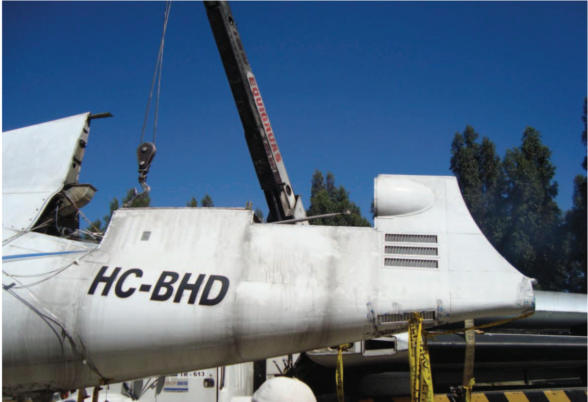
Figura 35. Sitio donde se instaló el estabilizador horizontal
