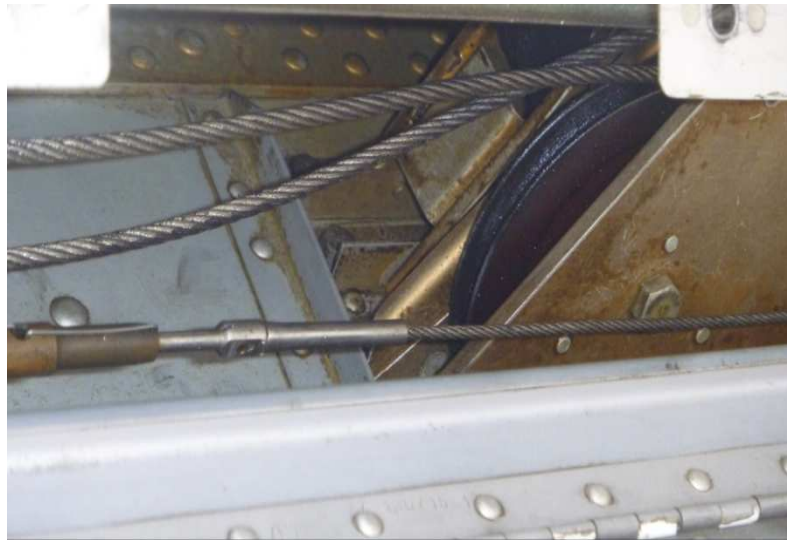
Figura 2.28: Cables de Control Fuente: Jéniffer Mendoza (Avión Fairchild FH-227 HC-BCD) Elaborado por: Jéniffer Mendoza
