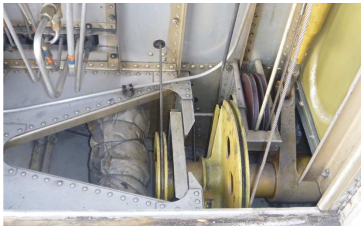
Figura 3.11: Poleas en el compartimento 122
