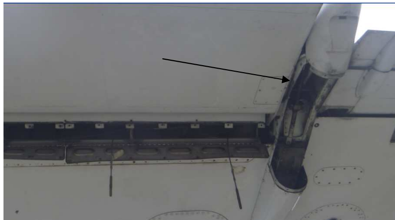
Figura 3.31: Articulación del alerón sin las tapas
