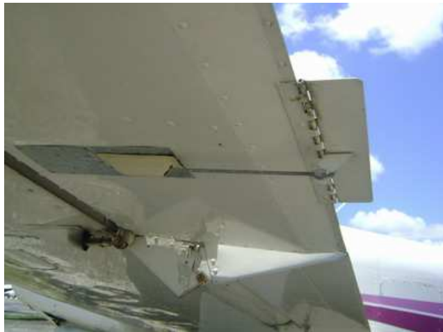
Figura 2.13: Trim Tab / Aleta de compensación
