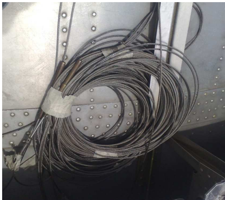
Figura 3.17: Cables de control liberados.
