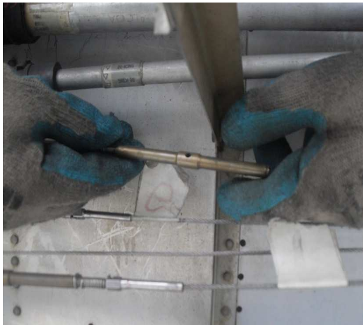
Figura 3.4: Desconexión de los Turnbuckles en el ala central
