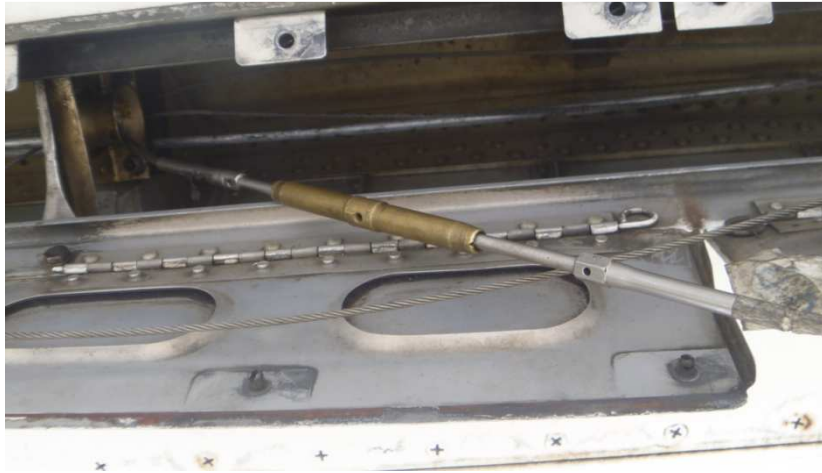
Figura 3.18: Turnbuckles de los cables de los trim tabs
