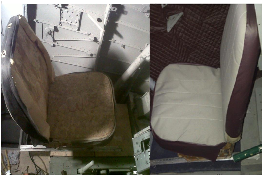
Figura 3.19. Instalación y tapizado de asientos
