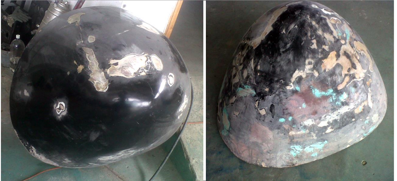
Figura 3.21. Nariz en tratamiento de fallas
