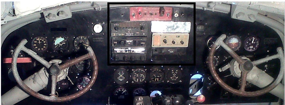
Figura 3.17. Montaje de instrumentos de comunicación y navegación
