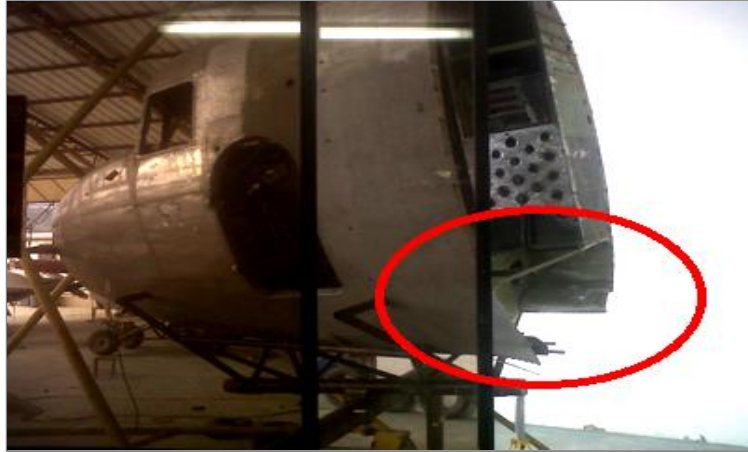
Figura 3.3. Sección posterior destruida
