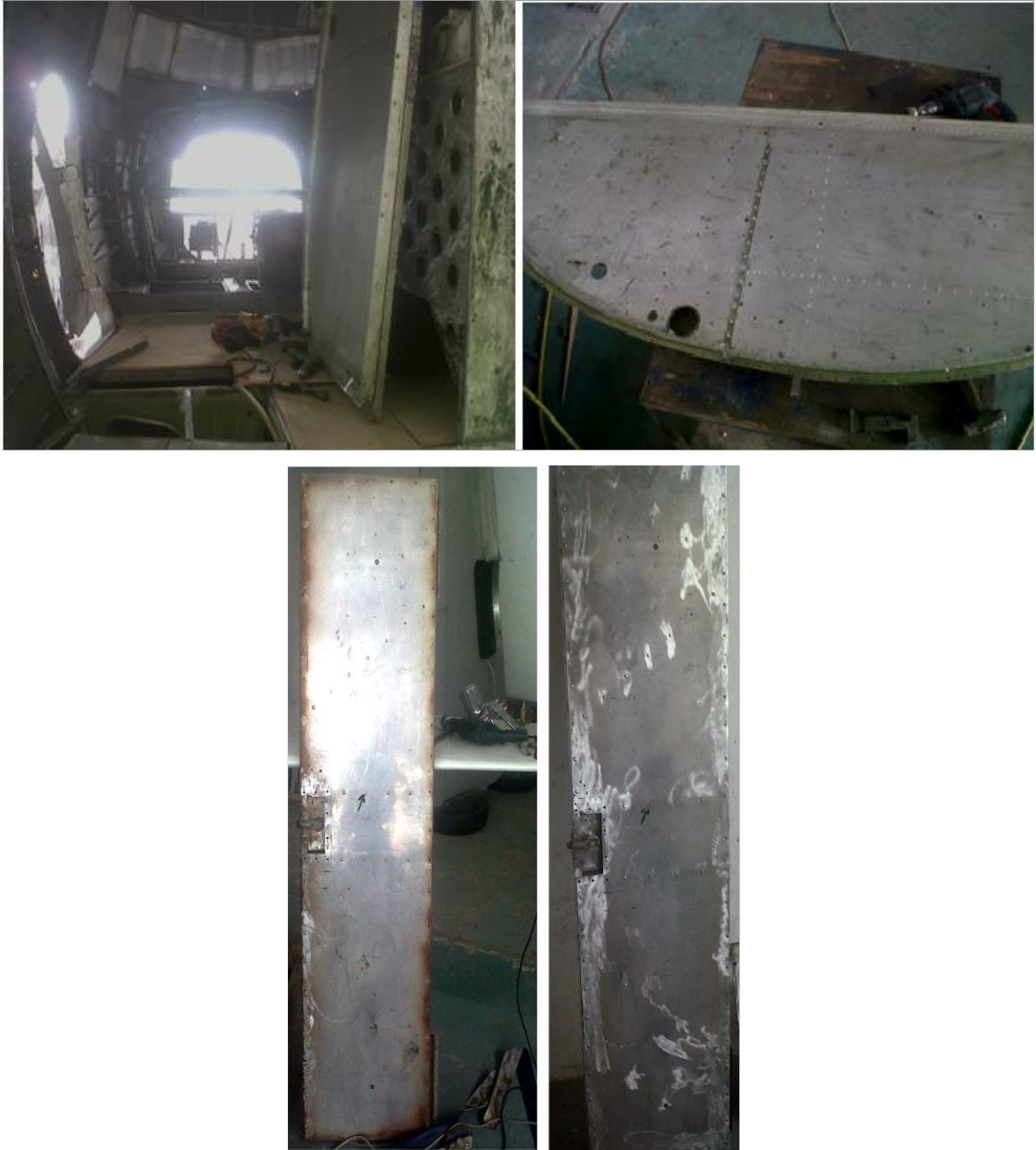
Figura 3.9. Conjunto de puerta en desmontaje y mantenimiento
