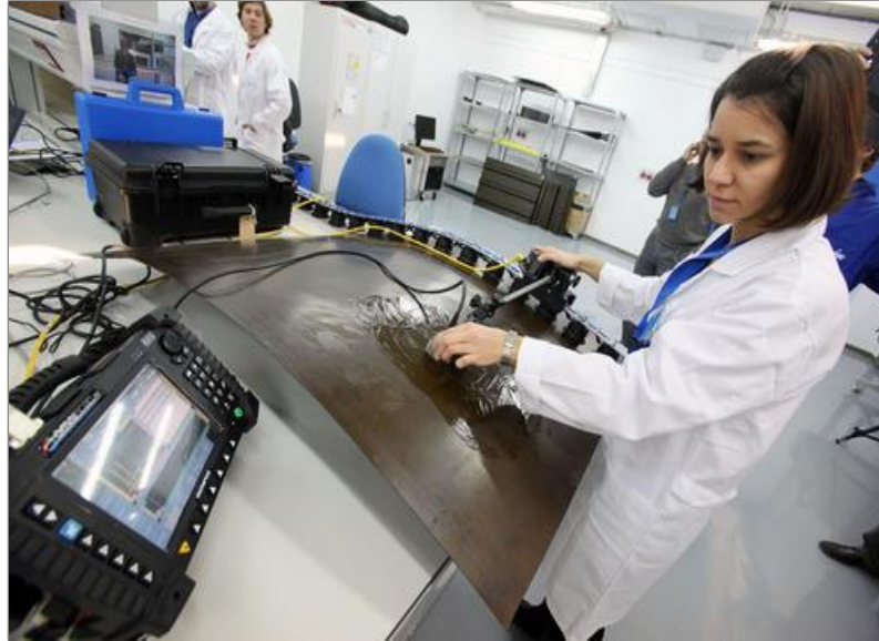
Figura 2.30. Inspección por ultrasonido
