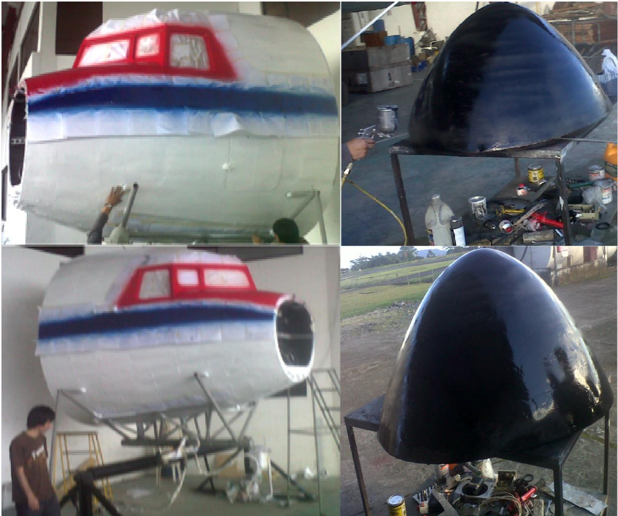
Figura 3.25. Cabina y morro en proceso de pintado
