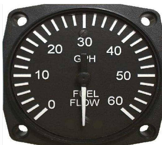
Figura 2.18. Indicador de flujo de combustible
