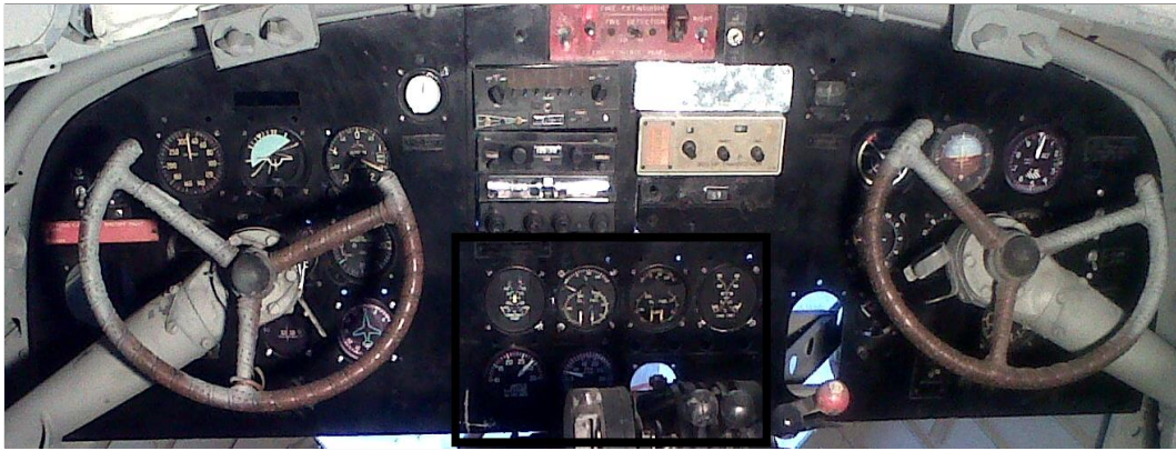
Figura 3.16. Montaje de instrumentos del panel del motor
