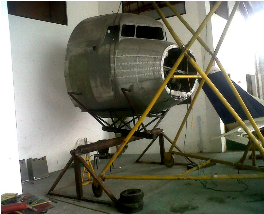
Figura 3.2. Cabina montada en estructura
