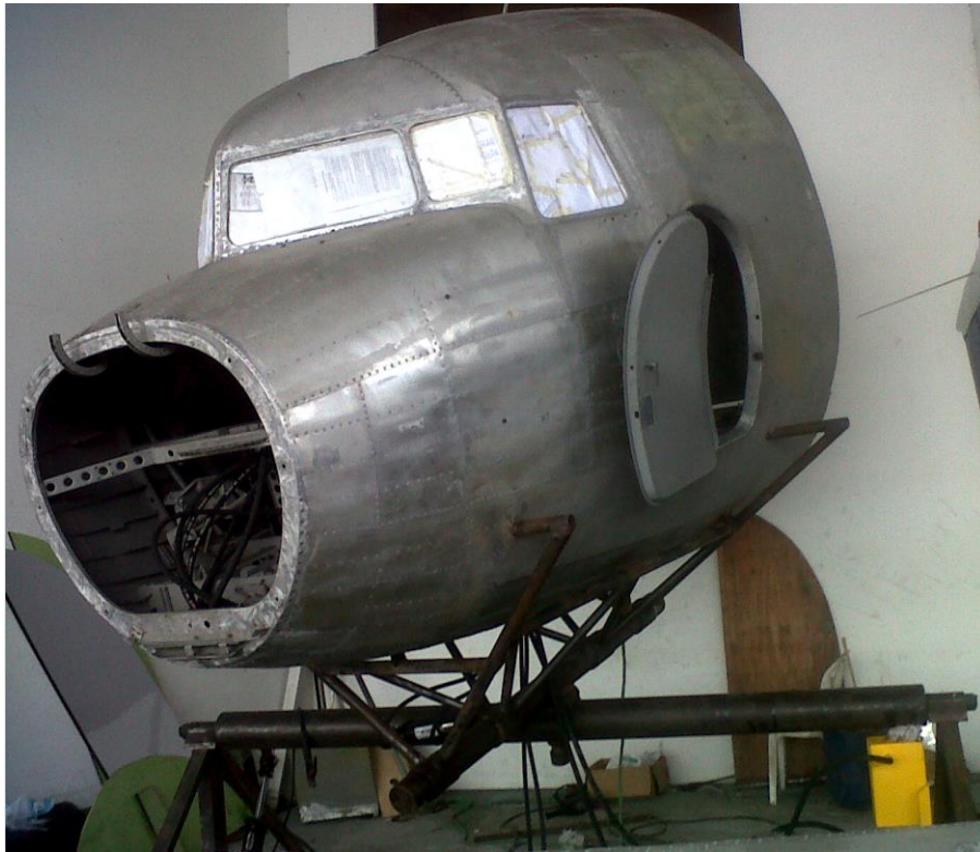
Figura 3.22. Remoción de corrosión
