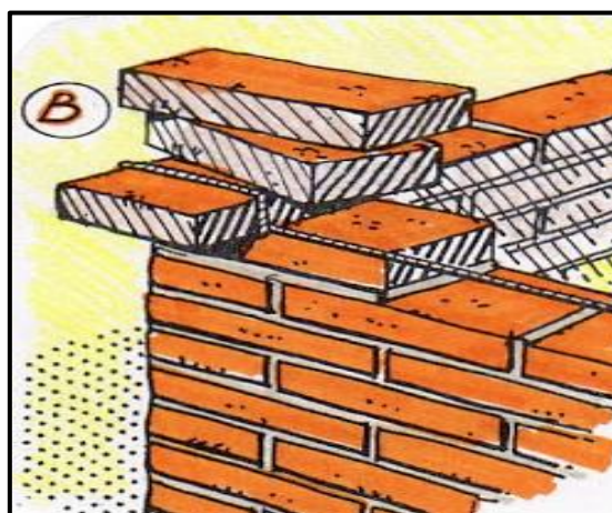
Figura 3.14 Levantamiento de la pared lateral izquierda
