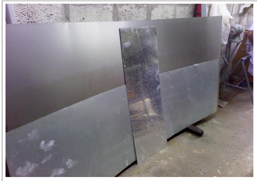
Figura 3.2 Láminas de acero de 1 20 in cortadas
