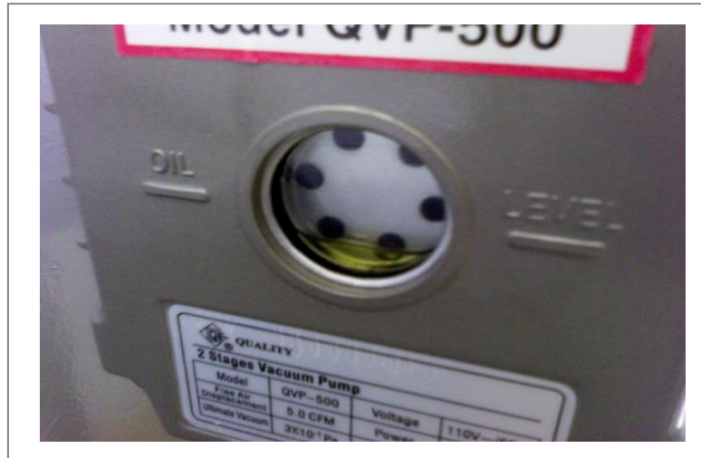
Figura 3.10 Indicador de nivel de aceite
