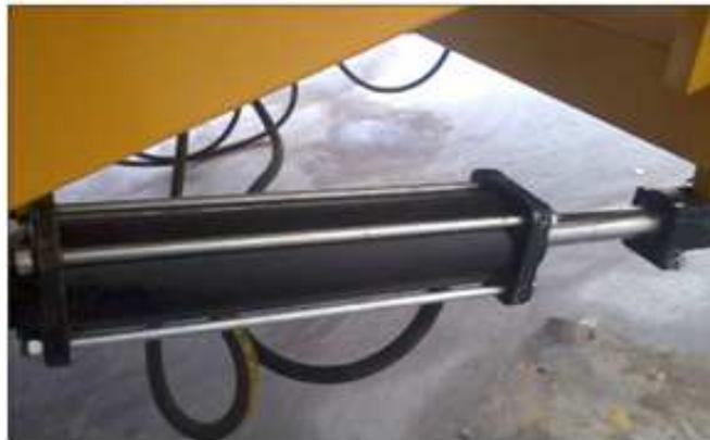
Figura 3.5. Cilindro Hidráulico
