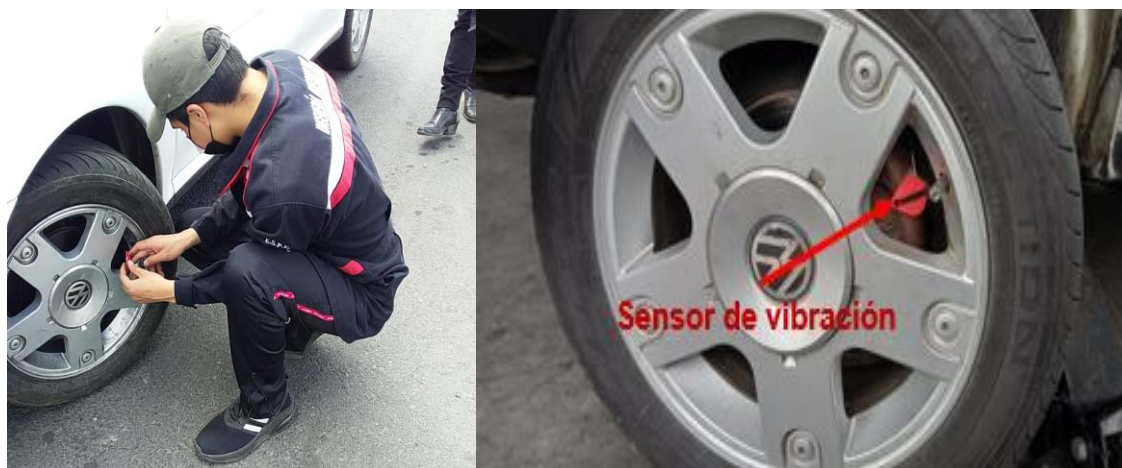
Instalación del sensor de vibración
