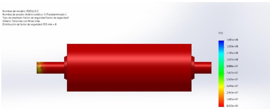
*Nota.* Simulación del factor de seguridad producido en el segundo escenario.
