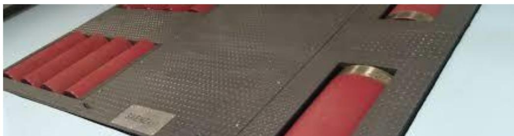
*Nota.* Estructura dinamómetro de rodillos. Tomado de saenzdynos, 2014.
