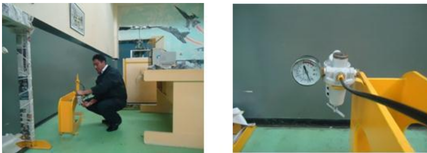
Figura 3. 12. Acople unidades de mantenimiento
