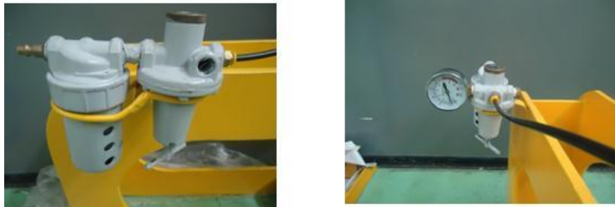
Figura 3. 7. Unidades de mantenimiento
