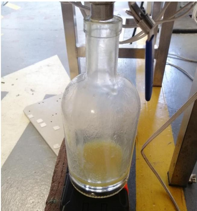
En la figura 116 se muestra el producto obtenido en la prueba automática. La primera cantidad de producto generado, estuvo afectada por los residuos presentes en la máquina, debido a la prueba anterior; por tal motivo se puede observar el envase de mayor capacidad con un color más oscuro; mientras que los envases pequeños contienen líquido de mayor pureza que se obtuvieron en el tramo final del proceso de pirólisis.
