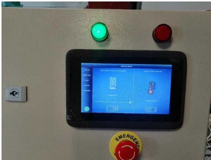
En la figura 111 se muestra la pantalla de control manual para la presión, en este caso se muestra el valor de la presión atmosférica y también su respectivo actuador que se utiliza cuando hay un diferencial de presión mayor a 5 PSI, ya que esto indica que hay una presión relativamente alta, la cual ocurre por los gases generados en el interior del reactor y se debe de aliviarla con la válvula de escape.
