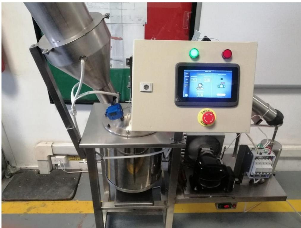
Se comienza verificando el funcionamiento de la parte manual, visualizando el calentamiento del reactor, en la figura 107 se puede ver la pantalla que muestra la temperatura del reactor que está en 314°C, debido a que, se hizo un calentamiento previo y con ello también se puede verificar la corriente que se está entregando en ese momento a la carga que es de 3.14A, como se visualiza en la figura 108.
