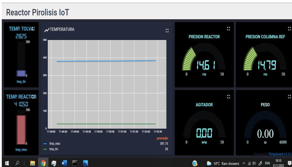
Al haber excedido la temperatura de 410°C en el reactor, se enviará un mensaje al correo notificando lo acontecido, figura 118, de tal forma que se puede estar alerta del proceso en cualquier momento, sin importar que se esté observando el HMI o la plataforma de IoT.
