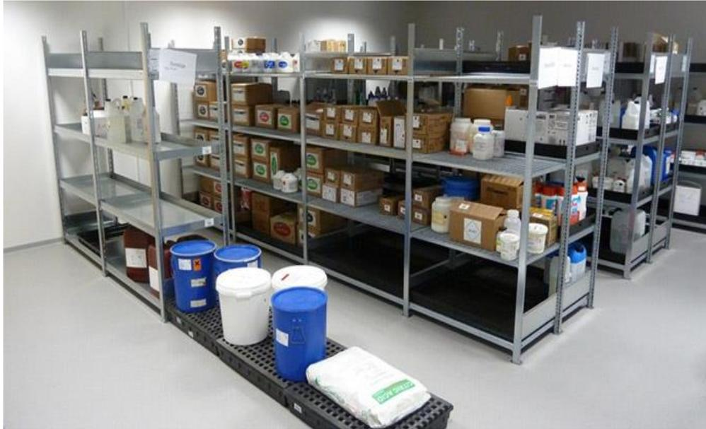
**Figura 2.3** Almacenamiento correcto de disolventes y desengrasantes utilizados en aviación
