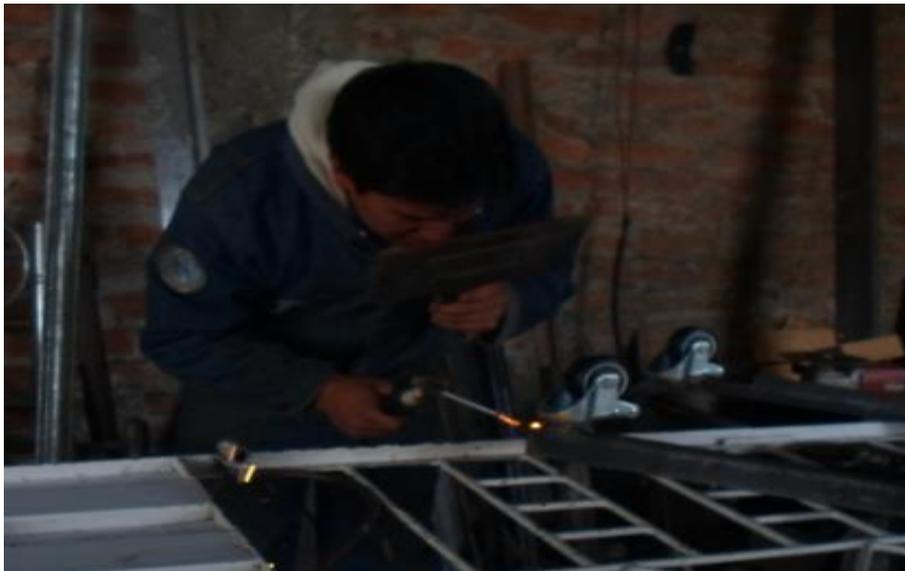
**Figura 3.24** Unión de las partes bases con suelda eléctrica
