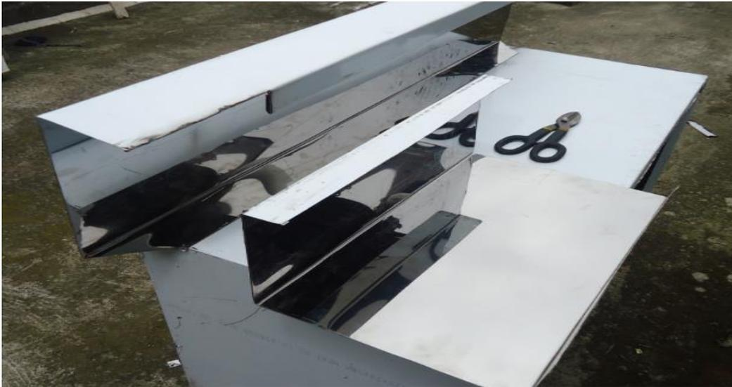
**Figura 3.3** Corte y doblado de la parte superior de la estructura
