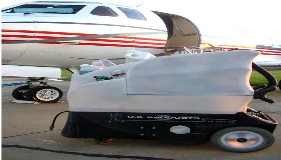
**Figura 2.2** Equipo para tareas de limpieza del avión
