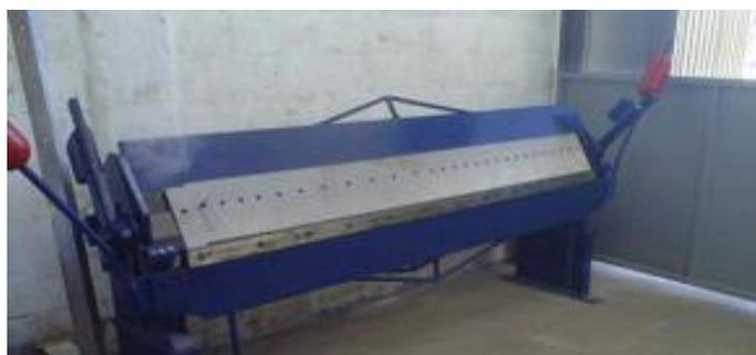
**Figura 2.38** Dobladora de láminas manual
