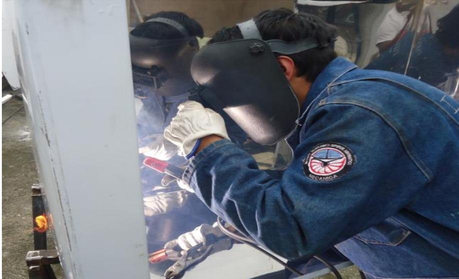
**Figura 3.9** Fijación de estructura con suelda E309L-16
