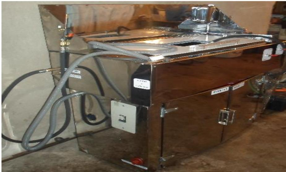
**Figura 3.26** Lavadora de partes y productos aeronáuticos
