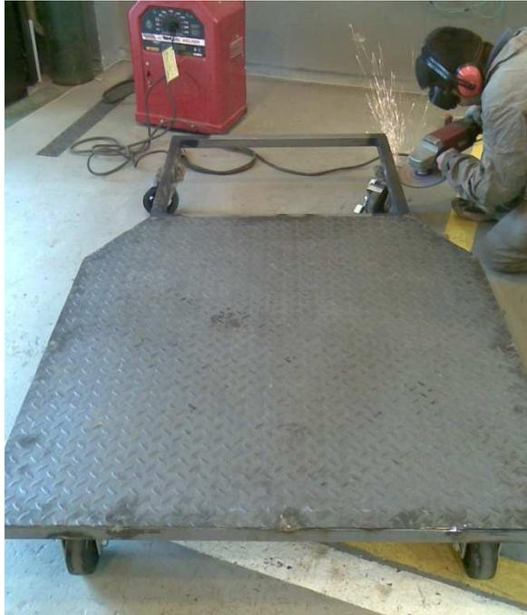
*Figura 3.40 Culminación de base y desbaste de excesos de soldadura*
