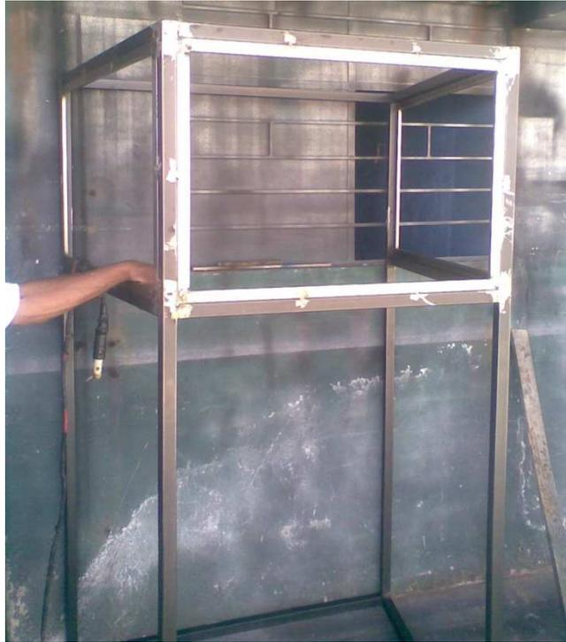
*Figura 3.41 Estructura de la cabina*
