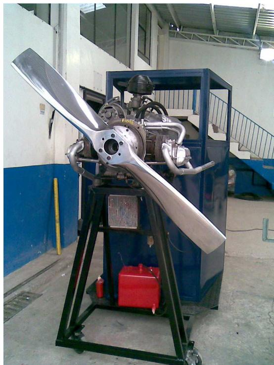
Figura 3.49 Bancos de pruebas para un motor recíproco
