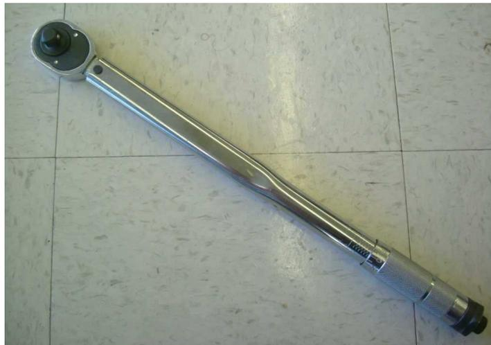
*Figura 3.32 Llave dinamométrica*
