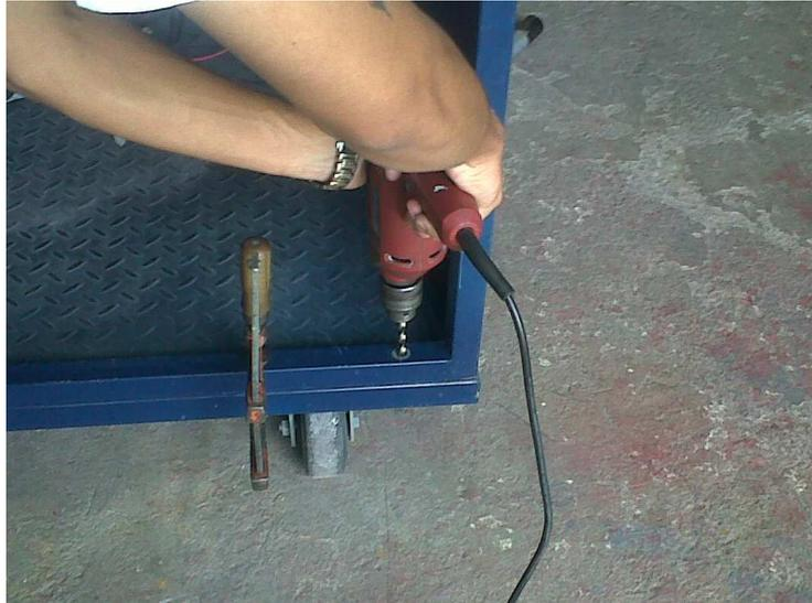
Figura 3.45 Orificios entre la base y la cabina de mando
