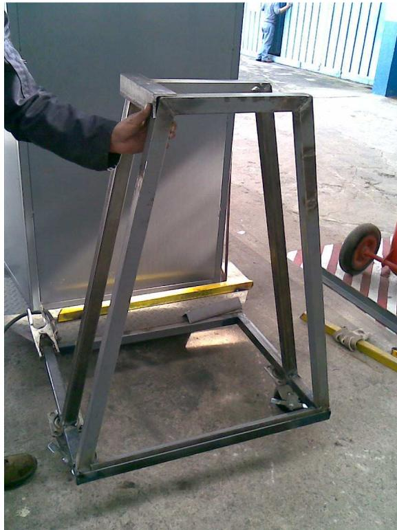
*Figura 3.43 Mesa para soporte del motor*
