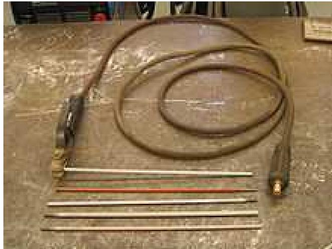
*Figura 2.7 Electrodos revestidos*
