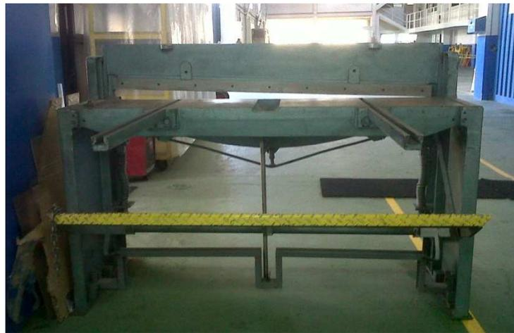
*Figura 3.34 Cizalla de pedal*
