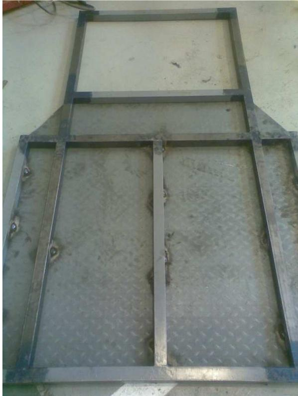
*Figura 3.39 Barras principales de la base y puntos de soldadura entre la estructura y láminas de acero antideslizante*
