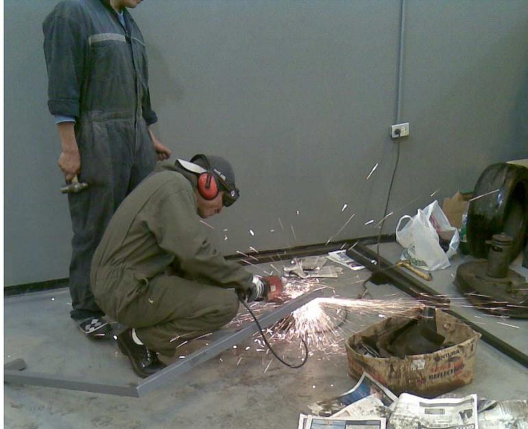
*Figura 3.38 Corte y reconstrucción de la base*
