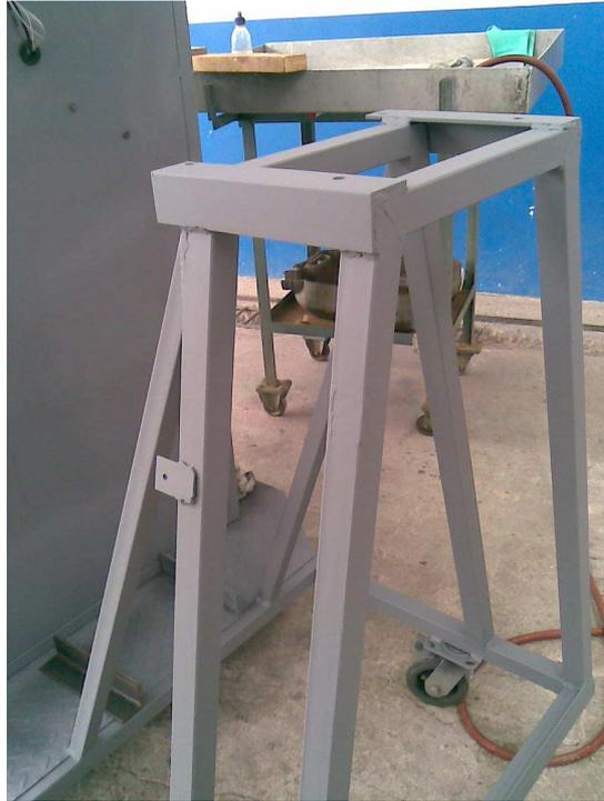
*Figura 3.46 Pintura base del soporte y cabina*
