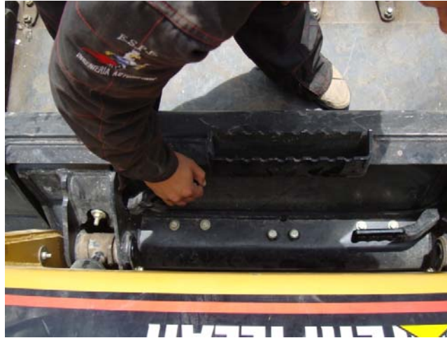
Figura 5.4 Seguros del acople universal
