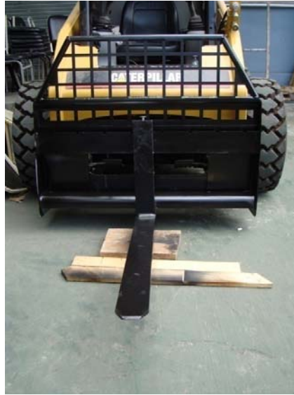
Figura 5.16 Colocación de la uña
