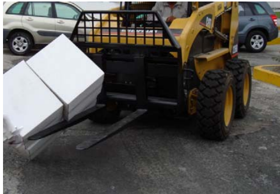
Figura 5.42 Perdida de carga
