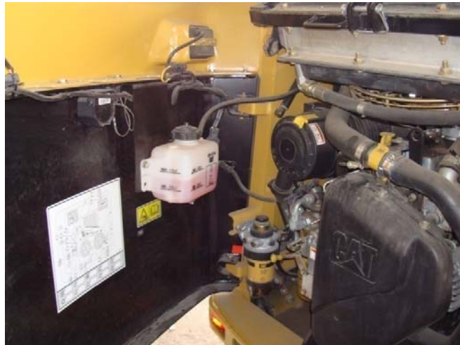
Figura 5.29 Niveles de motor
