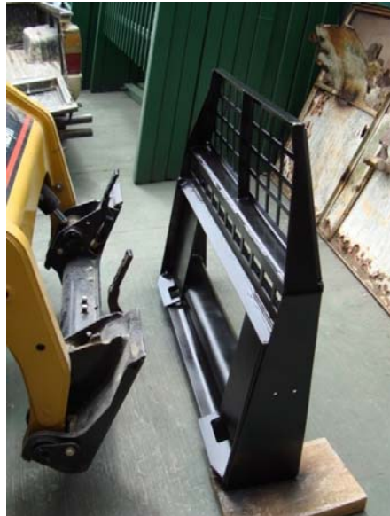
Figura 5.9 Proceso de acoplamiento del espaldar
