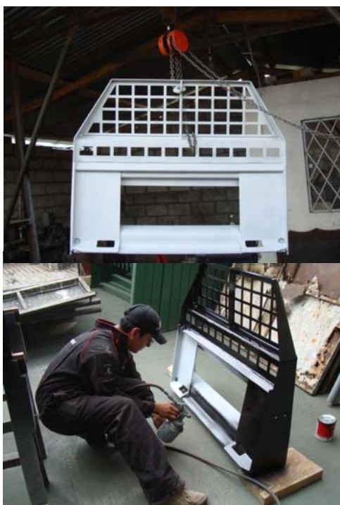
Figura 4.15 Proceso de fondeado y pintura
