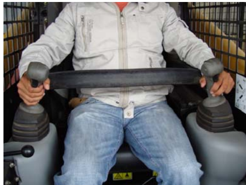
Figura 5.31 Barra de seguridad
