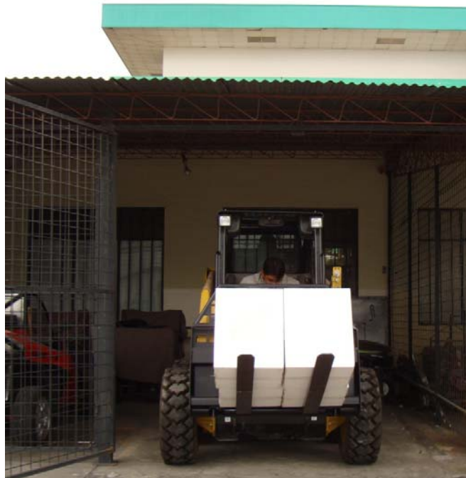
Figura 5.36 Horquilla inclinada para movilización
