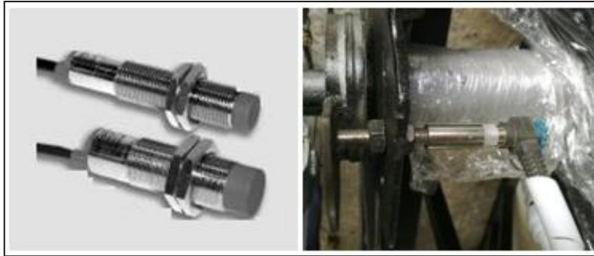
Figura 3.15 Sensores de velocidad de las ruedas
