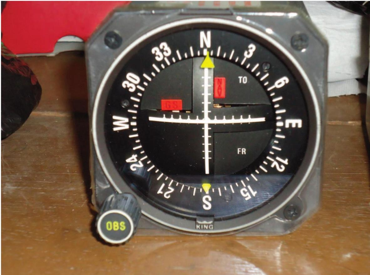
**Figura 3.20. Indicador de dirección de vuelo**
