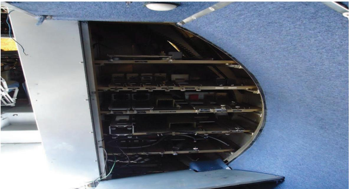
**Figura 3.38: Compuerta lateral del compartimiento electrónico**
