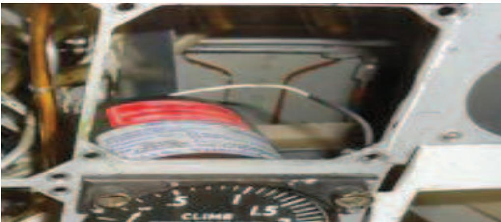
**Figura 3.33: Orificio donde está ubicado el indicador de radio magnético**
