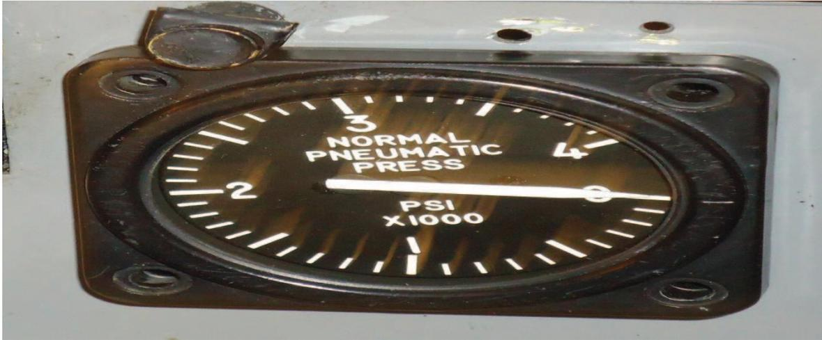
**Figura 3.16: Instrumento de la presión normal neumática**
