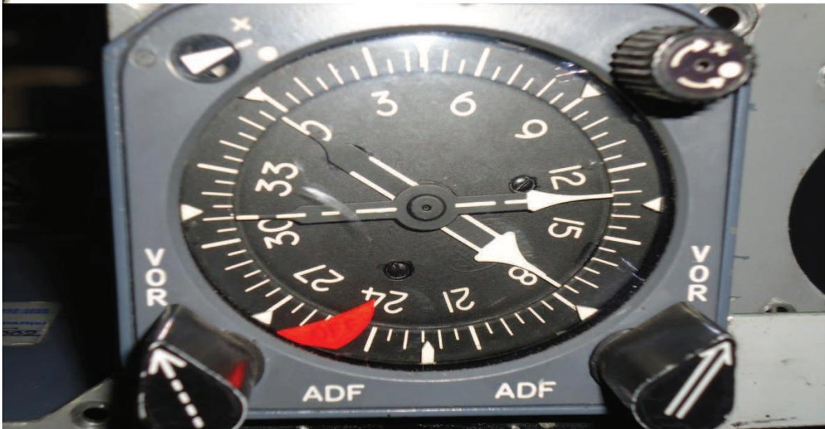
**Figura 3.30: Indicador de radio magnético**
