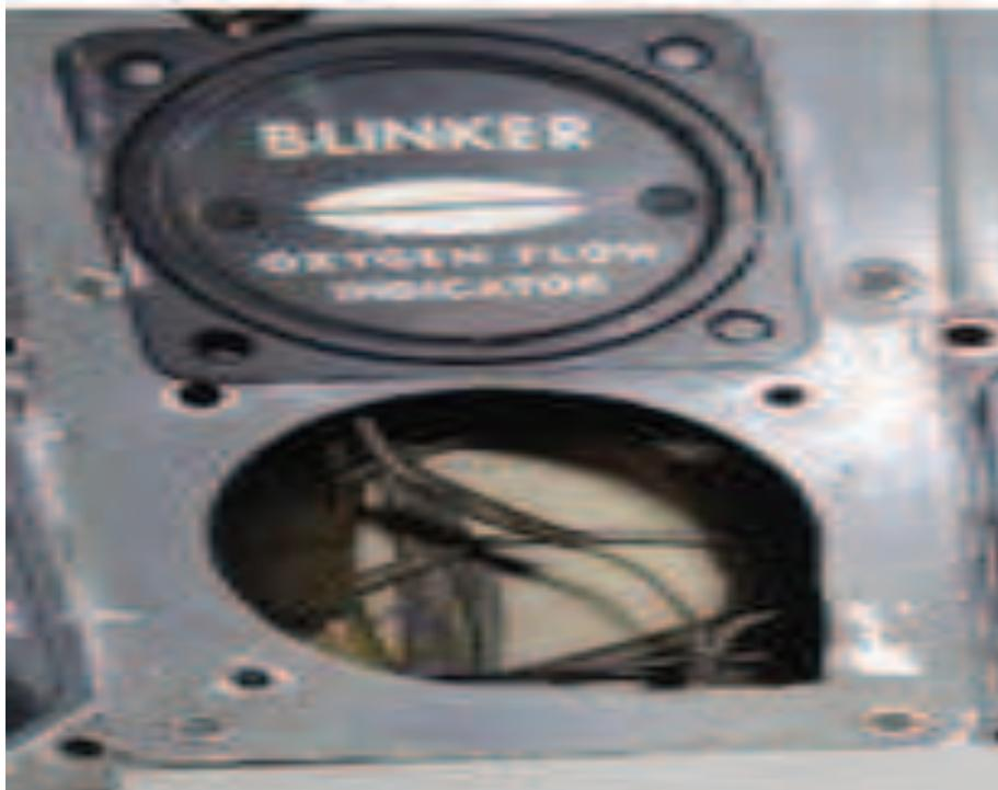
**Figura 3.10: Instrumento indicador de flujo de oxígeno**
