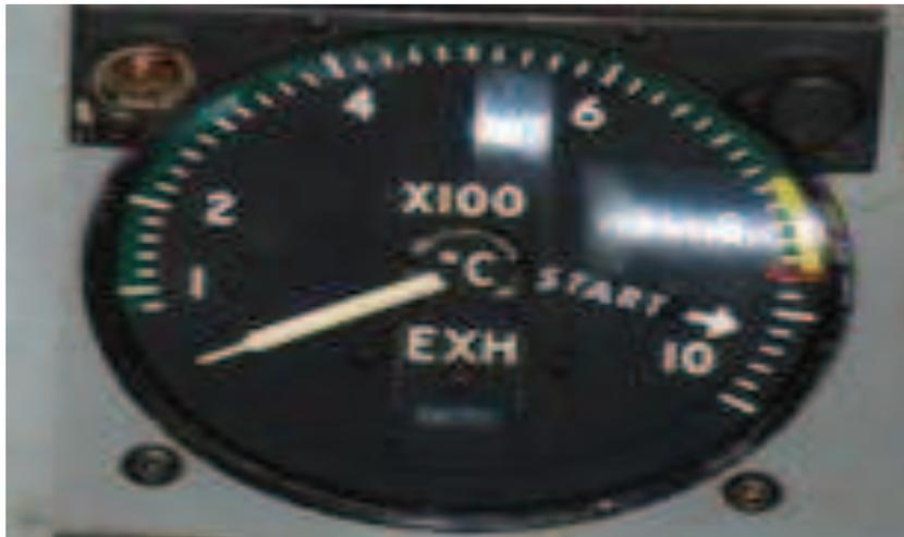
**Figura 2.16: Medidor de temperatura de gases de escape**
