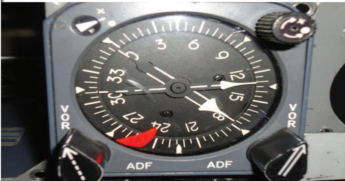
**Figura 3.8: Indicador de radio magnético**
