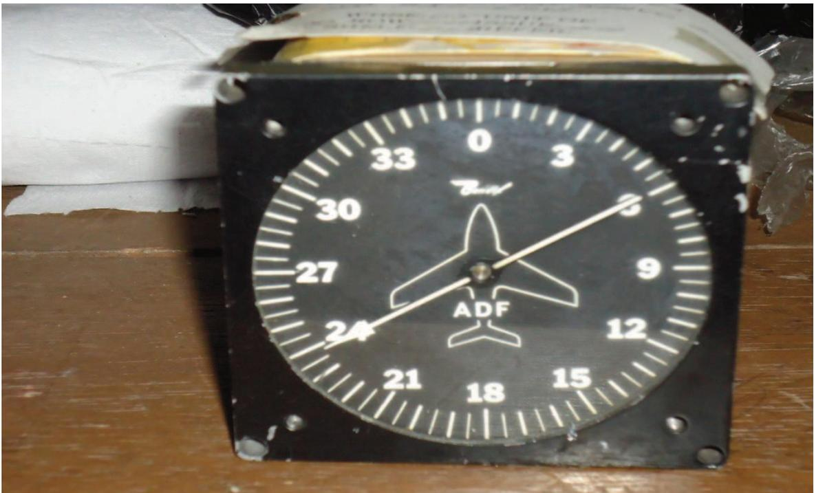
**Figura 3.34: Indicador de radio magnético**
