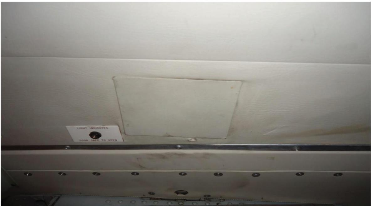
**Figura 3.40: Tapa del orificio del techo de la parte interior del avión**
