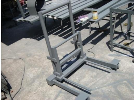
**Figura 3.22:** Pintado de la plataforma con fondo anticorrosivo
