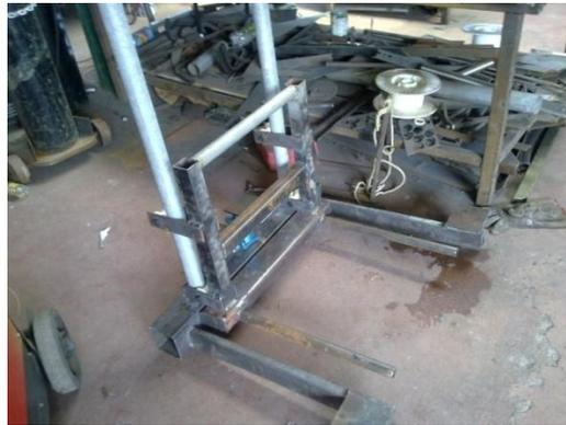
**Figura 3.18:** Soldadura de tubos cilíndricos de 1 ½ pulg y platinas
