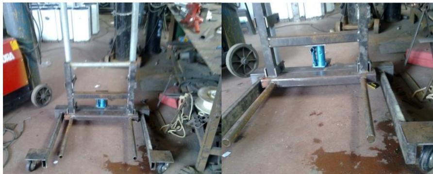
**Figura 3.19:** Montaje de ruedas giratorias y relleno de partes huecas
