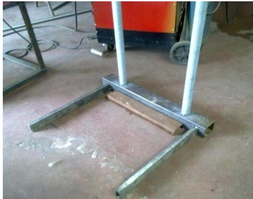
**Figura 3.14:** Base para la estructura de la plataforma
