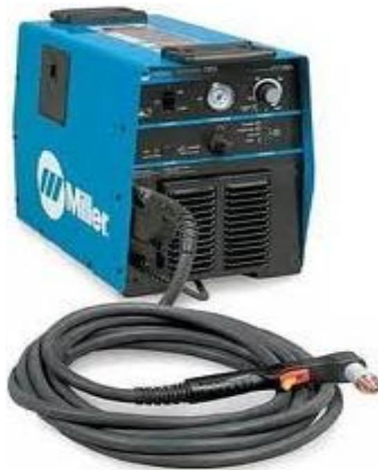
**Figura 2.33:** Cortadora de plasma manual
