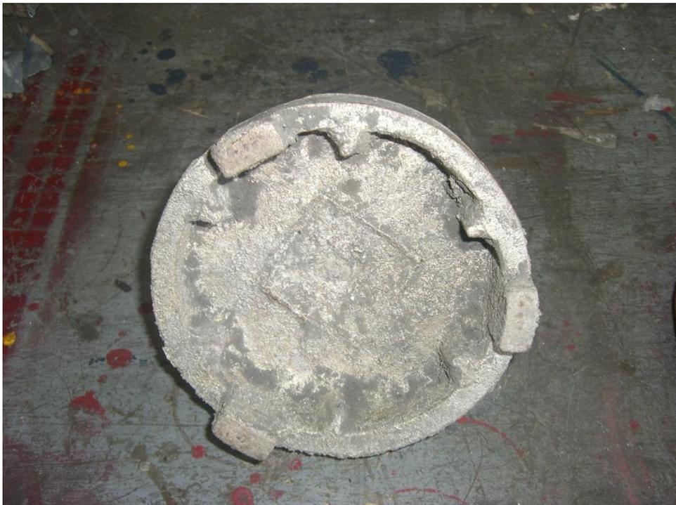
**Figura 3.24:** Parte inferior del molde del adaptador NLG
