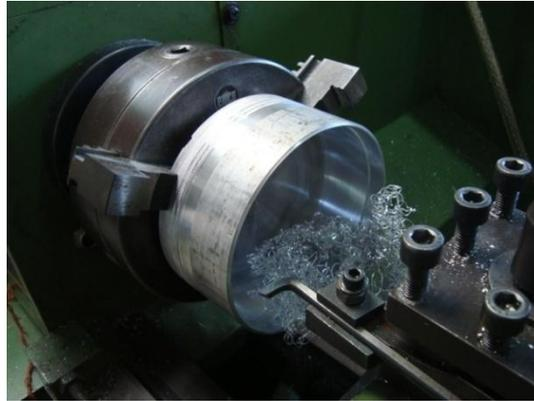
**Figura 3.34:** Desbastado y cilindrado de la parte interna del protector
