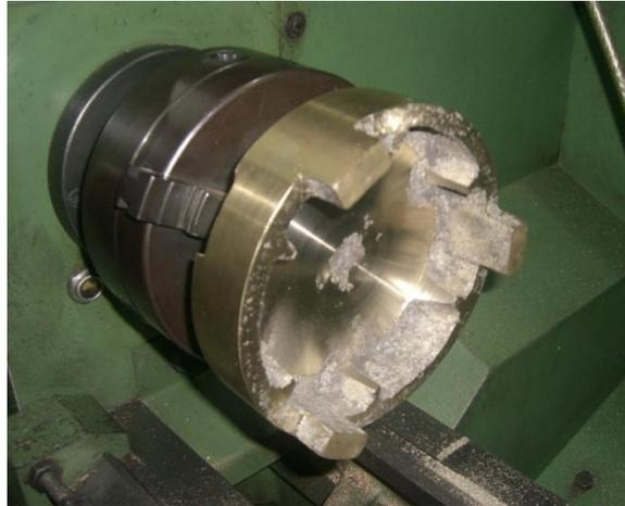
**Figura 3.27:** Acabado de la parte interna del adaptador
