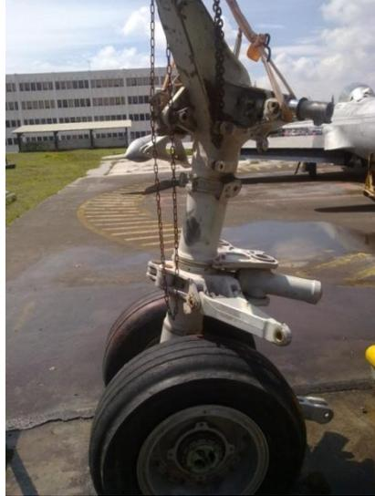
**Figura 3.10:** Pulverizado con Thinner y limpieza completa
