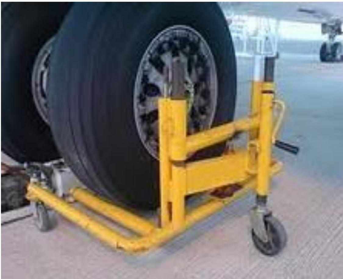
**Figura 2.21:** Plataforma rodante para cambio de neumáticos
