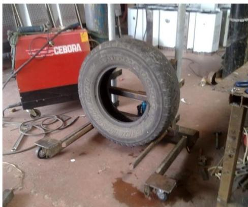
**Figura 3.21:** Prueba de la estructura de la plataforma
