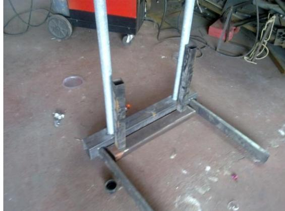
**Figura 3.16:** Corte de tubos cuadrados de 2 pulg y perfil C
