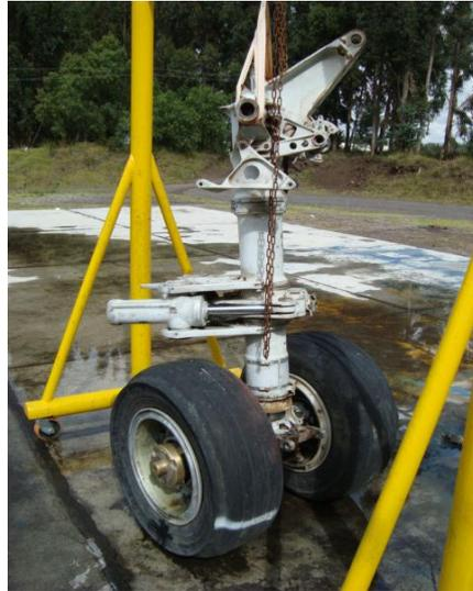
**Figura 3.8:** Pulverizado con desengrasante alrededor del tren
