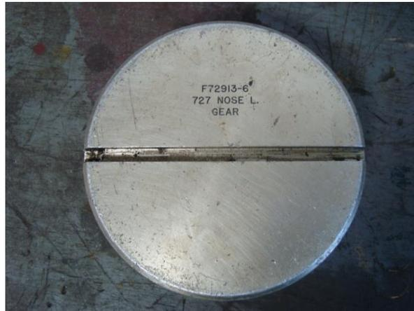
**Figura 3.32:** Ranura de ajuste o desajuste del protector
