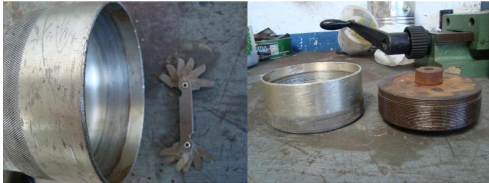
**Figura 3.36:** Comprobación con el medidor de paso de hilos
