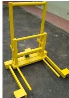
**Figura 3.23** Pintado de la plataforma con pintura sintética y su terminado
