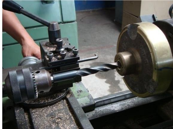
**Figura 3.29:** Perforación de la parte media del adaptador
