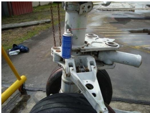
**Figura 3.7:** Limpieza del tren con agente removedor
