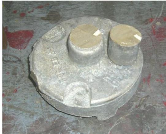
**Figura 3.25:** Parte superior del molde del adaptador NLG
