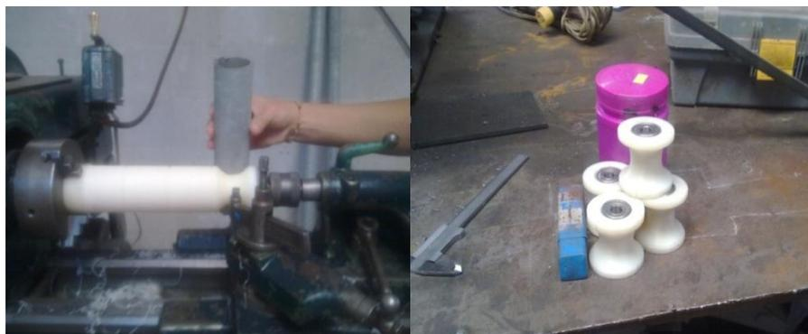
**Figura 3.15:** Moldeado de rodillos de nylon
