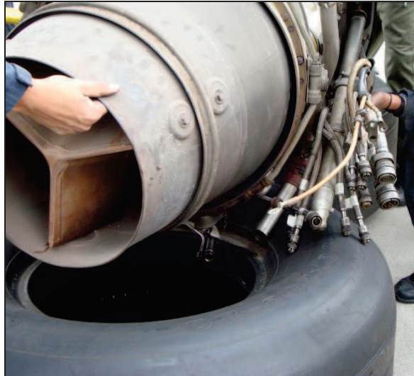
Figura 3.20: Motor asentado en neumáticos.
