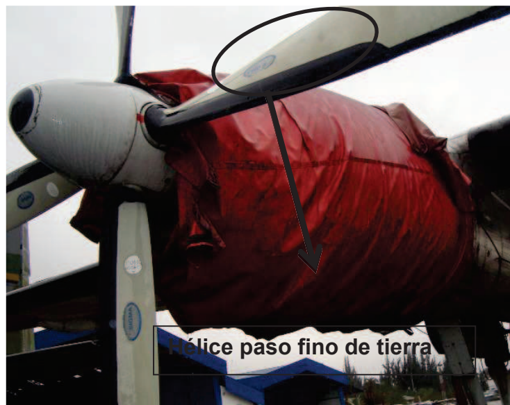
Figura 3.1: Hélice en paso fino de tierra.
