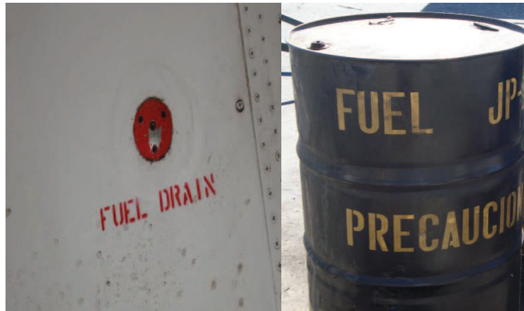
Figura 3.8: Punto de drenaje en el ala y recipiente.
