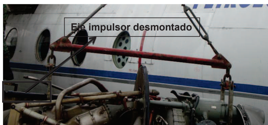
Figura 3.15: Eje impulsor desmontado
