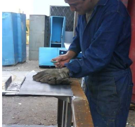
Figura 3.21: Medición de la plancha para las columnas de sujeción
