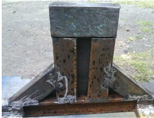
Figura 3.19: Soldado de las columnas para la sujeción
