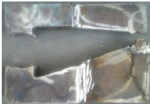
Figura 3.25: Sujetador del motor (Muelas de sujeción)
