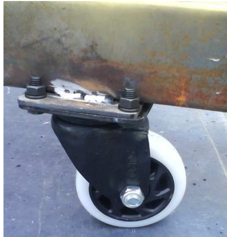
Figura 3.29: Ruedas Industriales acopladas en el soporte Fuente: Investigación de campo
