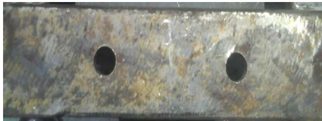
Figura 3.24: Orificios para el perno de los sujetadores del motor
