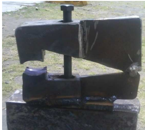
Figura 3.26: Sujetadores del motor (Muelas)
