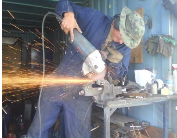
Figura 3.23: Corte de material para las muelas de sujeción
