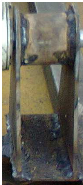
Figura 2.18 Proceso de ensamblaje de la base de sujeción lateral
