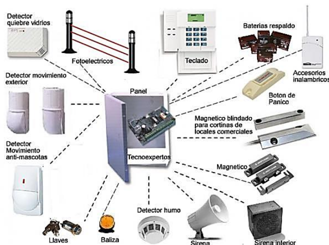
Componentes de una alarma de seguridad
