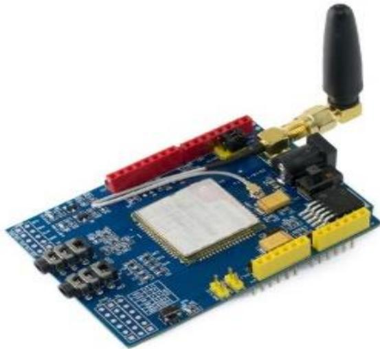
El módulo es compatible con todas las placas de Arduino y se configura y controla mediante el uso de sus puertos UART utilizando comandos AT simples.
