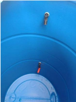
*Nota:* La siguiente figura muestra el montaje de los sensores de nivel de agua en el tanque.
