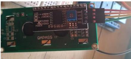
*Nota:* La siguiente figura muestra el módulo de I2C soldado a la pantalla LCD 1602
