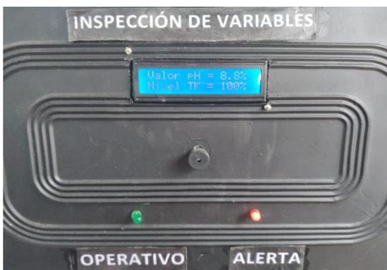
*Nota:* Operatividad del sistema de alarma al presentarse valores de pH no óptimos para el consumo del ganado. Encendido de luz roja y alarma audible.
