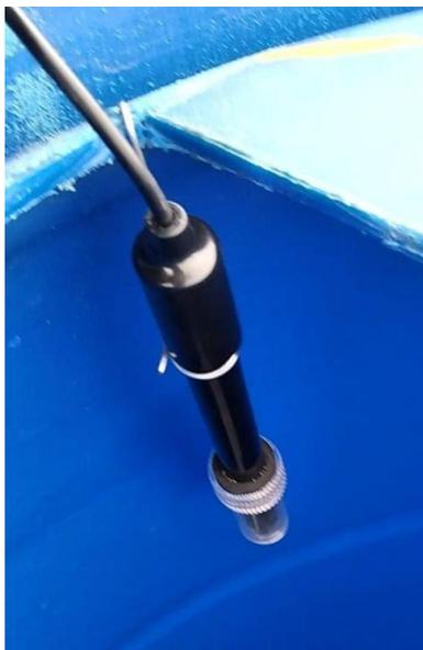
*Nota:* La siguiente figura presenta el sensor de nivel colocado en la parte superior del tanque principal.
