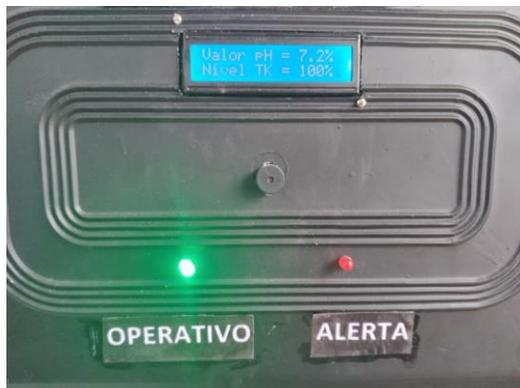
*Nota:* La figura presenta la caja de control con las debidas luces de indicación de operatividad del sistema, el valor de pH con porcentaje neutro y el tanque de almacenamiento en su capacidad máxima.
