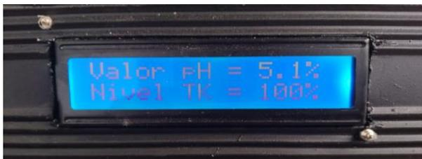
*Nota:* Visualización de la pantalla LCD con un valor de 5.1% debajo del rango óptimo para el suministro.
