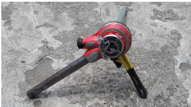
*Nota:* El siguiente gráfico muestra la realización de la rosca en tubería luego de haberse cortado las tuberías
