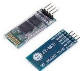
*Nota.* El gráfico representa al módulo Bluetooth que nos permite una conexión inalámbrica entre diferentes dispositivos. Tomado de (Caiza, 2008).
