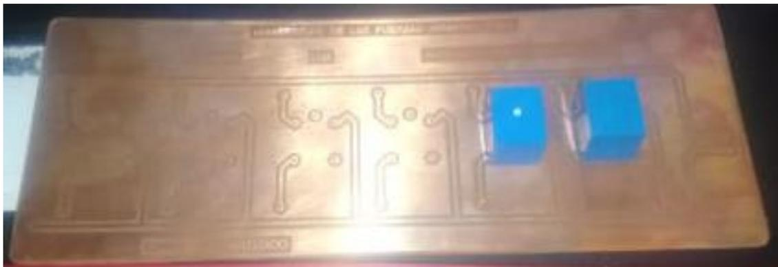
*Nota.* El gráfico representa al diseño de la pista para activación de los relés.
