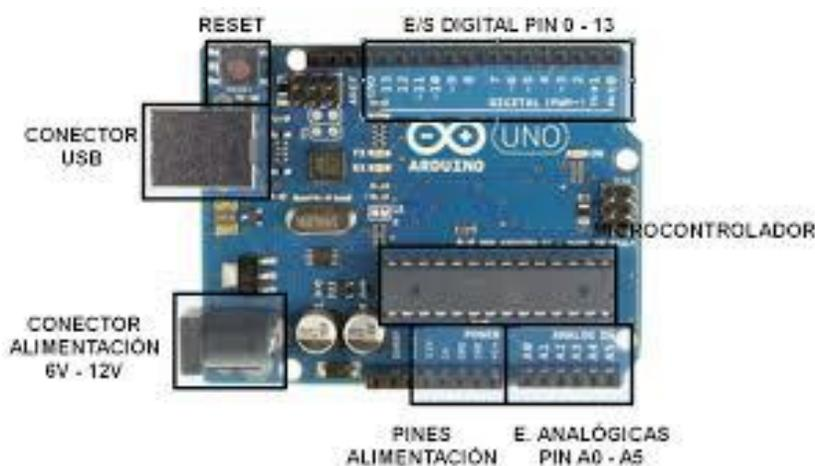
*Nota.* El gráfico representa a la tarjeta Arduino para entradas y salidas digitales y analógicas, incorpora señales PWM. Tomado de (TIENDA ROBÓTICA Y EL EQUIPO DE COSAS DE MECATRÓNICA, 2012)
