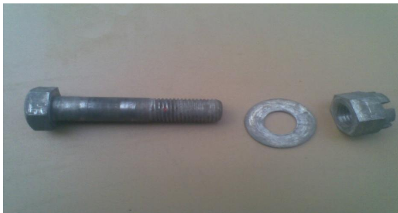
Figura 22. Pernos en mal estado
