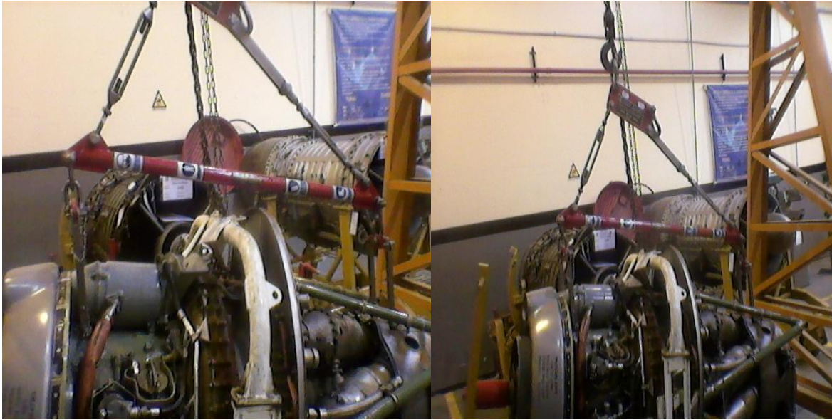
Figura 41. Izamiento del motor
