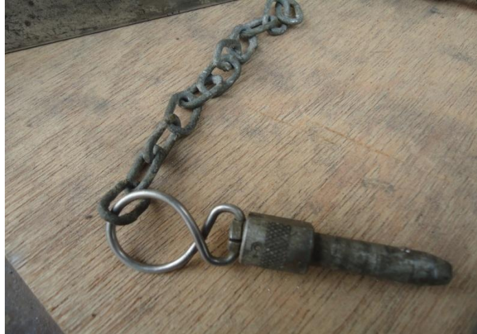
Figura 23. Pin Pip mal estado
