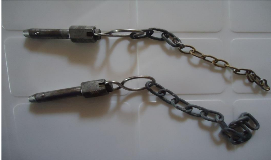
Figura 35. Pernos de liberación rápida dañadas las cadenas
