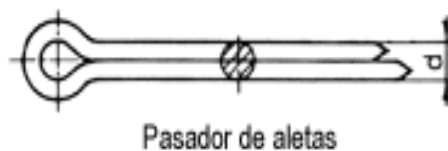
Figura 9: Retención de tuercas
