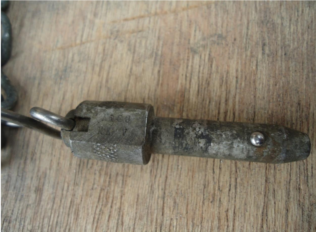
Figura 28. Perno de liberación rápida oxidado
