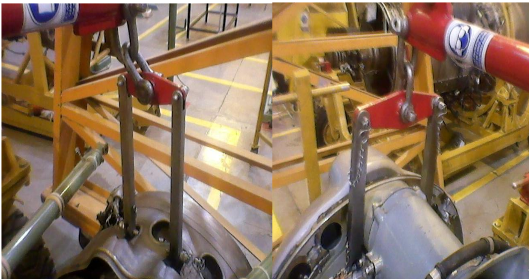
Figura 39. Acople del soporte al motor
