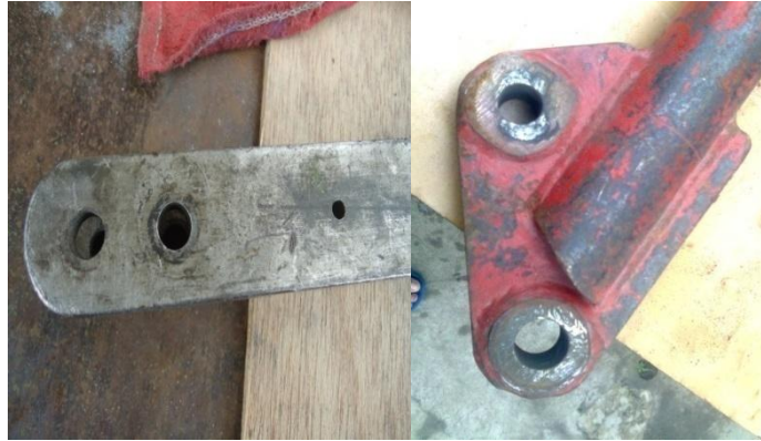
Figura 25. Partes del soporte desmontado
