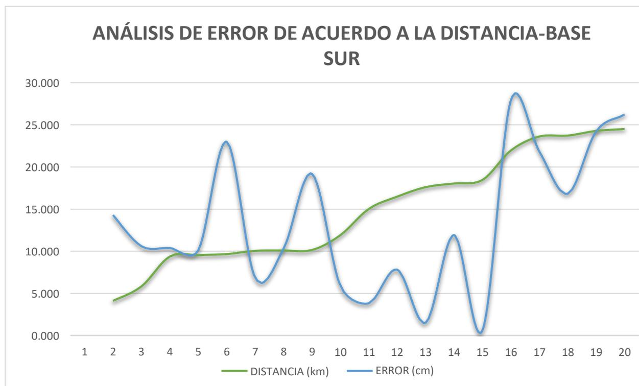
La aplicación RT-VPP calcula la altura nivelada en función a la base más cercana del punto a medir, en la *tabla 8* se compara las precisiones obtenidas respecto a la base norte, sur y las bases seleccionadas por la aplicación Android, ver *figura 48*.
