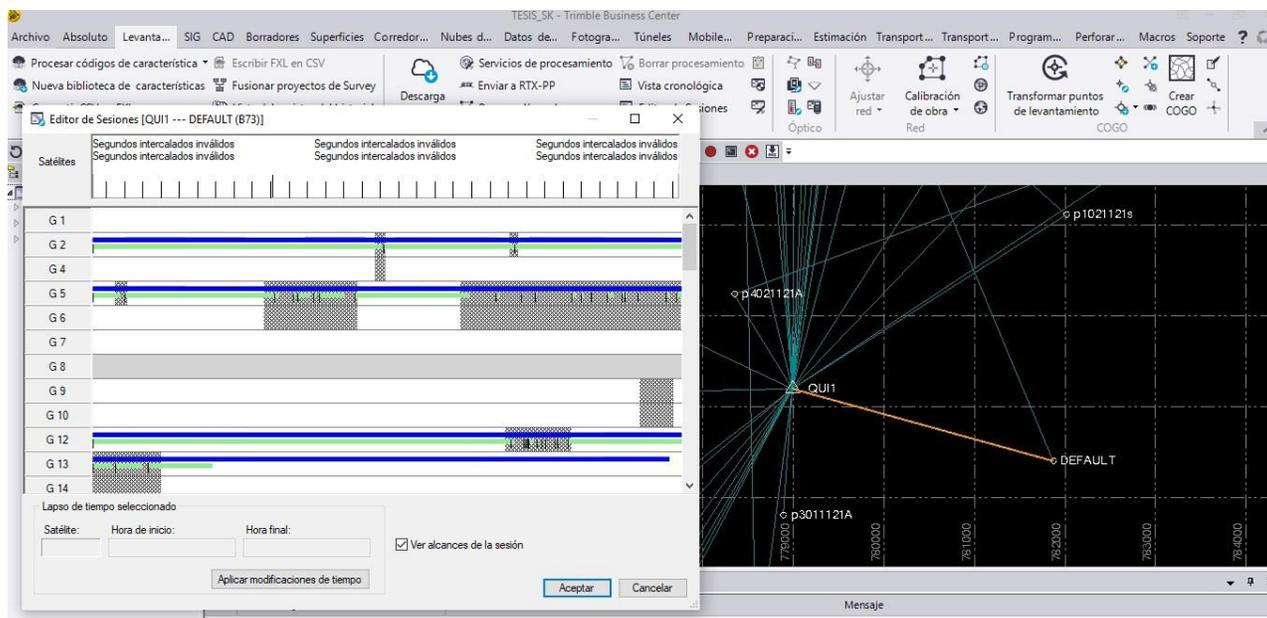
Una vez generado el informe de procesamiento de líneas base, se revisa el apartado de precisión vertical donde se descartó todos los puntos cuya precisión vertical sean mayores a 0.05 m, quedando los puntos indicados, ver *Figura 24*.
