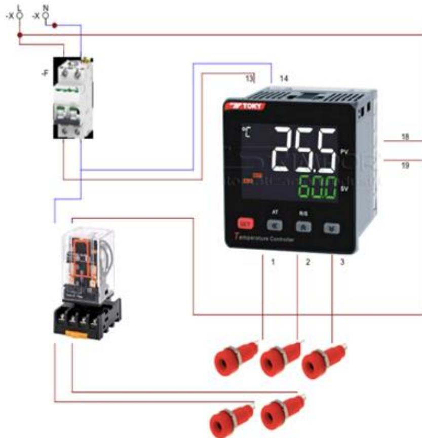
El controlador de temperatura funciona con una alimentación de 120VAC. Se agregaron jacks banana para la conexión del sensor de temperatura y un relé que es accionado a través de la salida de la Alarma 1 del controlador.
