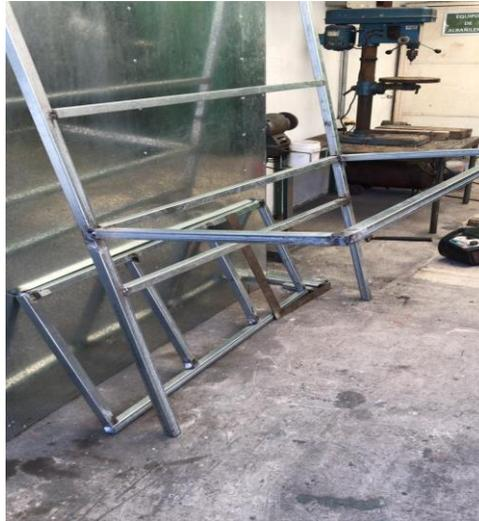
**Interpretación:** Se continúa uniendo las secciones, para soldar la parte superior del banco se utilizó una prensa para unir el tubo y levantarlo.
