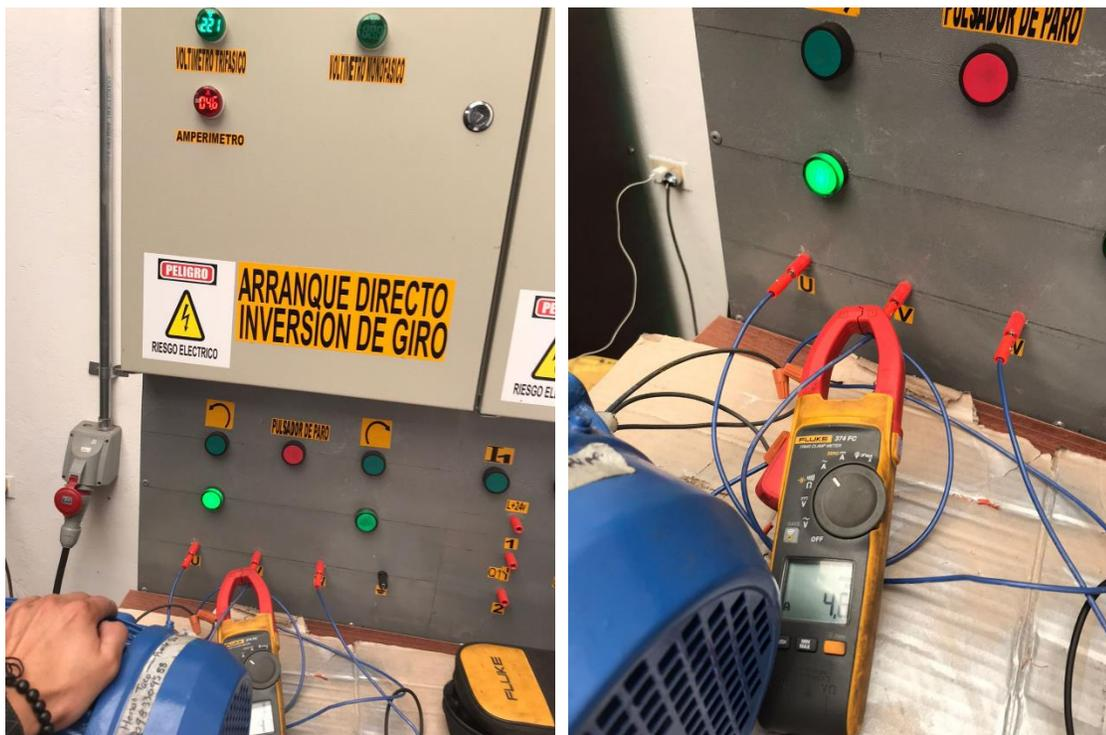
Los resultados obtenidos con los instrumentos del tablero son los mismos obtenidos con el multímetro con pinza amperimétrica, tanto de voltaje como de corriente, son los siguientes:
