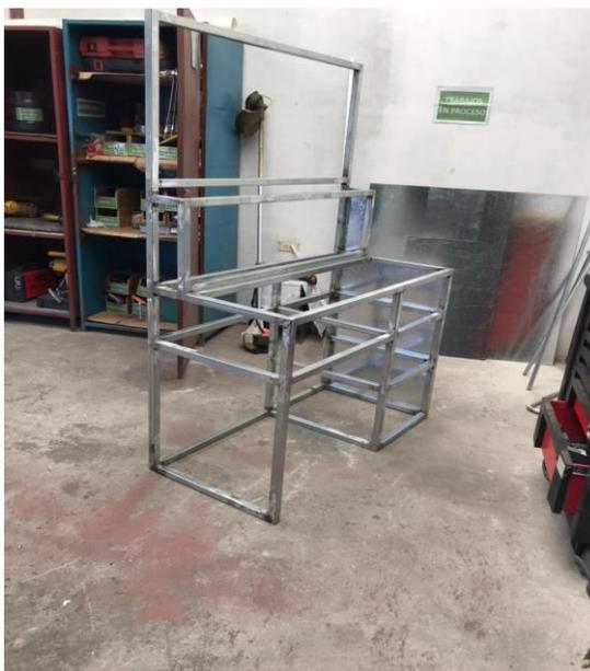
**Interpretación:** Terminada la estructura se procede a pulir con la amoladora con disco de pulir, esto con el objetivo de dejar lisa la estructura, verificar la calidad de la soldadura y dejarla lista para el trabajo de pintura.
