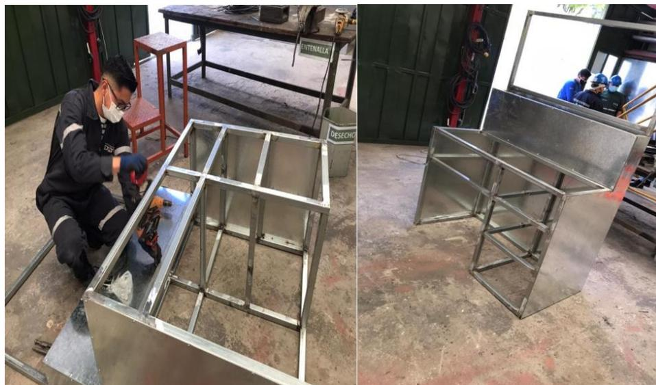
**Interpretación:** Se mide y coloca la plancha de tol en la parte posterior de la estructura con tornillos auto perforantes y en los costados con remaches ya que será fijos. En la parte posterior se ubicará los dispositivos eléctricos y electrónicos.
