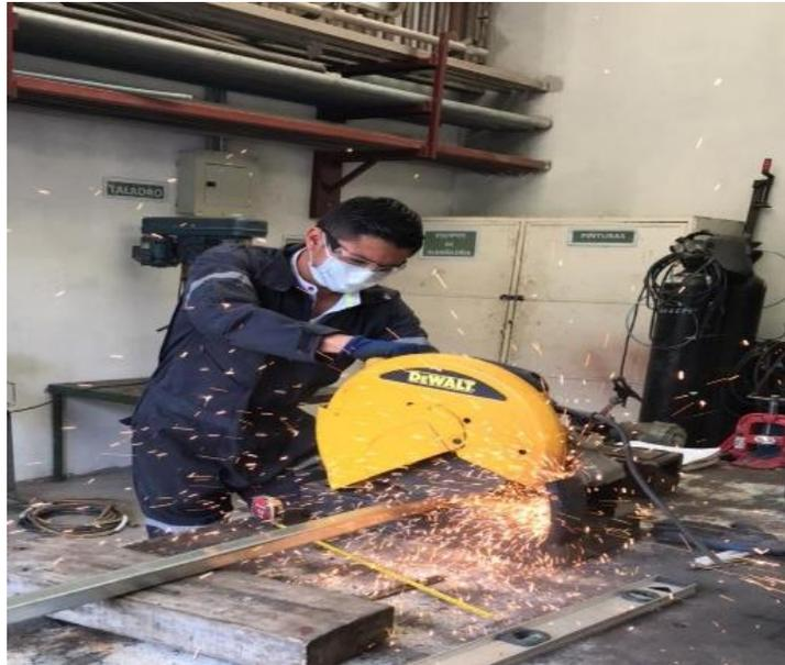
**Interpretación:** Se procedió a cortar todos los tubos cuadrados que conforman el tablero de acuerdo a las medidas del diseño realizado, para luego proceder a ensamblar cada parte de la mesa y soldar.
