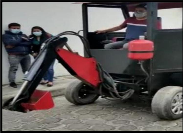
Prueba de funcionamiento del chasis con movimientos de la herramienta delantera.
