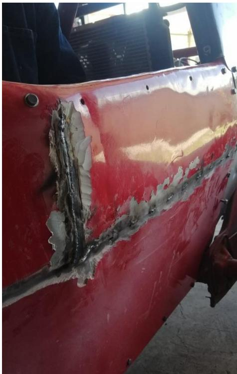
Es necesario realizar la unión de las cubiertas posteriores del motor, se muestra en la figura 72.
