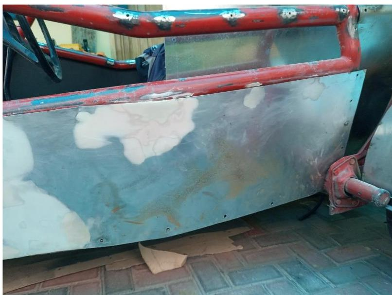
El siguiente paso, consiste en la comprobación de las piezas laterales, a fin de determinar su ubicación, dimensión y funcionamiento dentro del vehículo. En la figura 58, se muestra la comprobación de la instalación de las piezas laterales.
