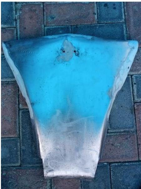
La parte delantera, está formado por un triángulo invertido redondeado, para su construcción y adecuación en el vehículo, se realizó considerando las dimensiones del vehículo. En las figuras 64 y 65, se muestra la preparación del capo del vehículo, su finalidad es cubrir el tanque de combustible el cual se encuentra en la parte delantera del vehículo.
