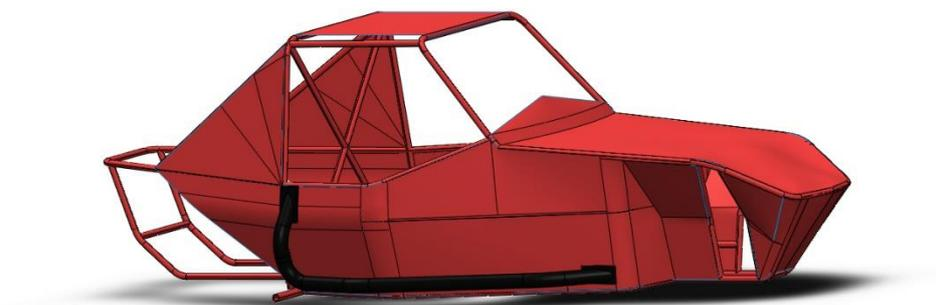
Como próximo paso se diseñó la parte posterior del bastidor, en esta parte del bastidor se encuentra el mayor peso del vehículo, ya que se encuentra el motor, los ejes de propulsión y la caja de transmisión. Además, en la parte posterior del bastidor estará la suspensión, el sistema de dirección y el tanque de combustible, tal como se muestra en la figura 53.
