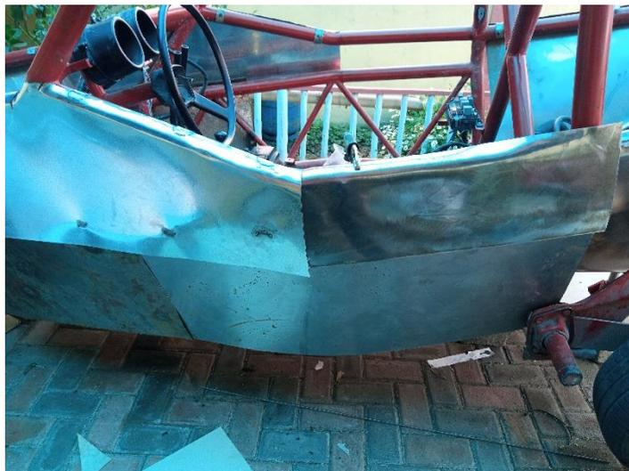
La parte superior se compone de dos trapezoides, uno de estos el delantero, que es redondeado para dar forma a la parte delantera del vehículo. Sobre estos reposan dos figuras geométricas básicas, un cuadrado y un triángulo rectángulo, estos conforman la parte del habitáculo del vehículo. Complementadas con formas circulares y rectas forman elementos decorativos del habitáculo del vehículo.
