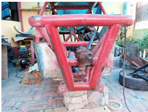
El siguiente paso, consistió, en la construcción y adecuación de la parte delantera del vehículo, el cual tiene la función de absorber deformación que puedan generarse de la energía desarrollada por un choque. La cubierta delantera elaborada, se ilustra en la figura 61, la cual debe estar alineada con los componentes delanteros del vehículo.
