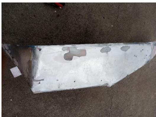
Posteriormente, se ensambló las piezas laterales del vehículo. El diseño para la parte lateral se genera desde un rectángulo base, que tiene como función soportar el techo y partes de las motos, el guardabarros, los espacios entre las llantas. En la figura 57, se muestra el ensamblaje de las piezas laterales.
