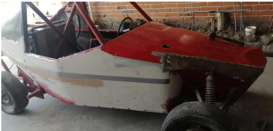
En este proceso es necesario tener las respectivas medidas de seguridad como también el equipo adecuado con la finalidad de no recibir daño físico durante el proceso de pintura. Cuando se pinta una superficie, se realiza un cambio estético y se contribuye a la protección del vehículo. Por lo que debe considerarse la viscosidad, estabilidad, color, poder cubriente, secado, dureza, adherencia, brillo, entre otras propiedades. Ver figura 88.
