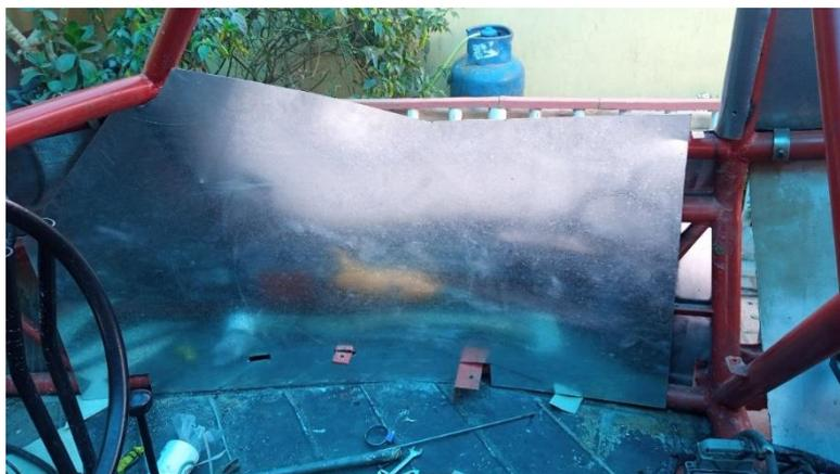
Para la cubierta lateral del motor del vehículo, se realizó por medio del moldeado de las láminas a ambos costados del motor; en las figuras 67 y 68, se muestran los pasos de construcción.
