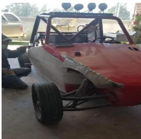
Una vez culminado el proceso de lijar, se procede a revisar el vehículo, si es necesario si existe imperfecciones y poder cubrirlas, tal como se muestra en la figura 83.
