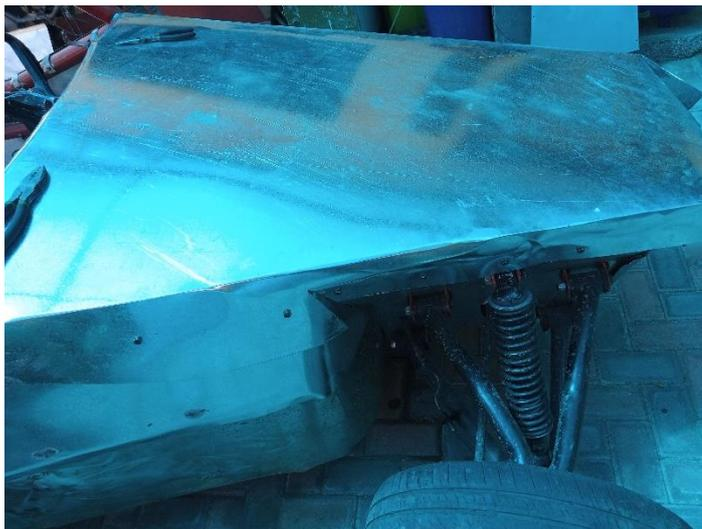
La siguiente fase del proceso de construcción, fue la manufacturación de la cubierta interna del vehículo. En esta fase se extrajeron los asientos a fin de poder adecuar la parte interior. En la figura 66, se muestra manufacturación de la cubierta interna.
