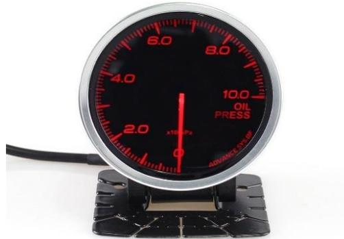
**3.6.3.1. Implementación.** Como se observa en la figura 46, la conexión del manómetro de presión de aceite es dada por un cable positivo y un cable negativo conectado directamente al sensor, este sensor se observa en la figura 47, a continuación, se conecta el cable rojo del manómetro a la batería, el cable blanco al switch de contacto, el cable amarillo al switch de encendido del motor y finalmente el cable negro se le conecta al negativo de la batería.
