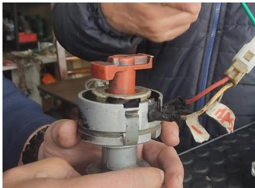
El distribuidor va conectado a la bobina de 3 cables como se observa en la figura 25. Su conexión se basa mediante el diagrama eléctrico que se observa en la figura 26
