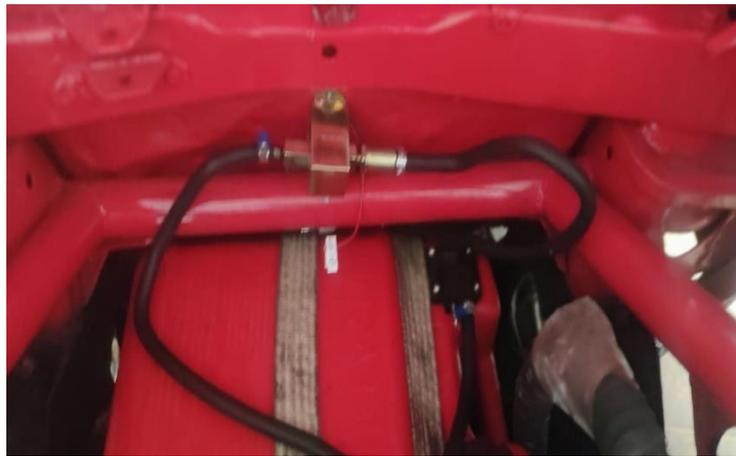
Como se observa en la figura 28 su conexión eléctrica es mediante un cable negro que va conectado a masa, y el cable rojo se le conecta al interruptor del panel de encendido, finalmente a cada extremo de la bomba de combustible se conecta una manguera dirigida hacia el tanque de combustible y del otro extremo una manguera dirigida hacia el carburador.
