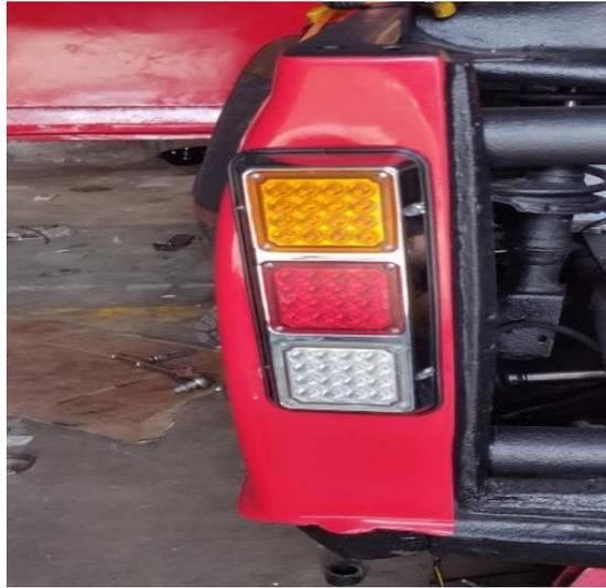
Mediante interruptores se le realiza su conexión para luces guía, luz de freno y luz de emergencia, la cual se manda mediante fusibles de 20 amperios estos conectados a una fusilera como se ve en la figura 37.
