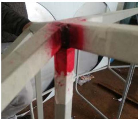
*Nota.* La tinta penetrante se sobrepasa a la cinta adhesiva para que en la pulverización sea en toda la superficie de la unión soldada.
