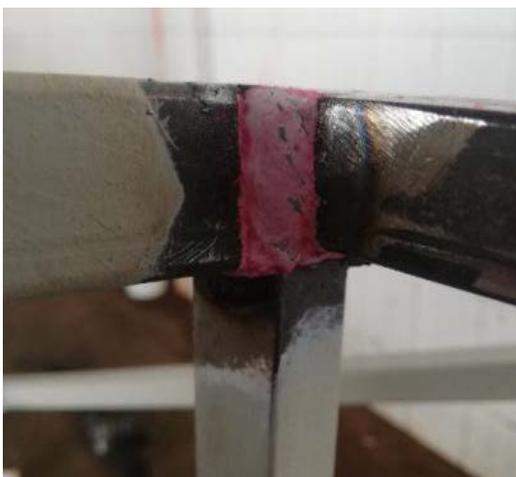
Finalizado el análisis del cordón y concedido la aprobación o rechazo de la misma se procede a retirar los restos del revelador de toda la superficie del cordón, se visualiza en la figura 40 el cordón limpio finalizado el ensayo.
