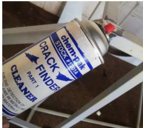
La limpieza realizada con el limpiador de partículas de polvo, restos de óxido o pintura se procede a la aplicación de la tinta penetrante viene en color rojo el cual se aplica a una distancia considerable entre 3 y 5 cm por lo que se aprecia una penetración a lo largo del cordón de la soldadura.
