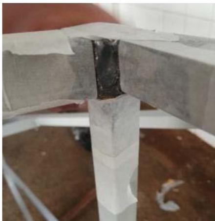
*Nota.* La envoltura con la cinta adhesiva evita que la tinta manche la tubería cuadrada de la estructura considerablemente hasta el alcance del rocío del aerosol.
