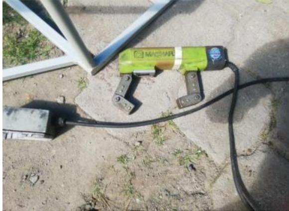
*Nota.* Yugo empleado en el ensayo por partículas magnetizables del buggy
