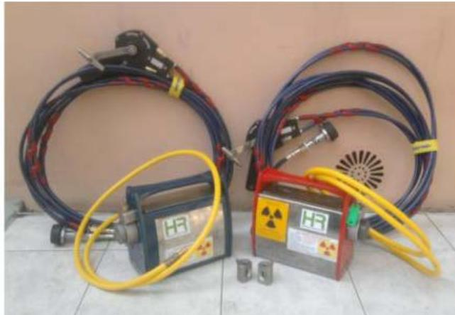
*Nota.* Herramientas de inspección por radiografía industrial de soldadura usados por HR Ingeniería. Tomado de (Carmona, 2013).
