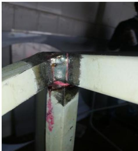
*Nota.* En la limpieza de la superficie del cordón se requiere cuidado para no exceder y retirar la tinta de las fallas de la superficie.
