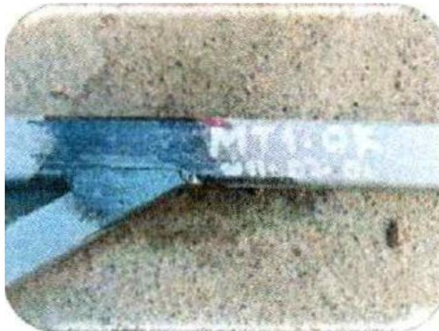
Para reconocer los cordones a los que se aplicará el ensayo en toda la estructura, se les cataloga con la siguiente etiqueta:
