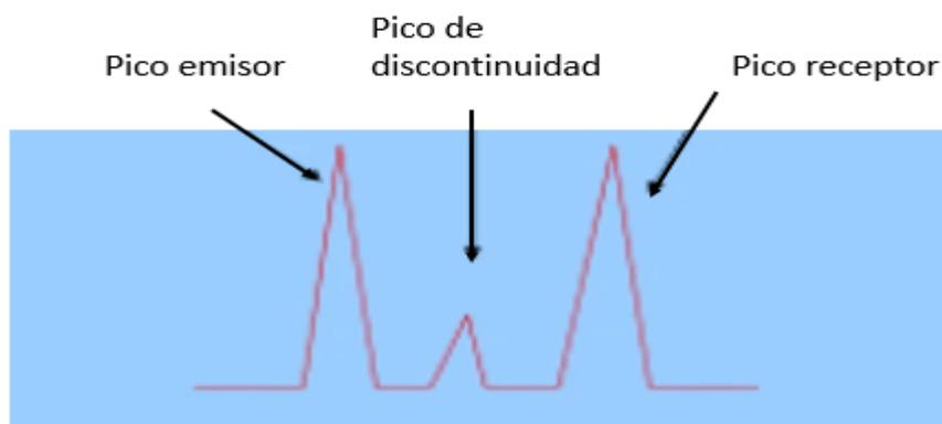
*Nota.* En el osciloscopio de no existir discontinuidad mostraría solo dos picos el emisor y el eco o pico receptor. Tomado de (Torres, 2011) Editado por Azogue Xavier.
