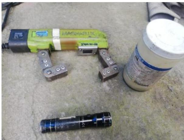
*Nota.* Se observa el yugo la linterna y las partículas de hierro previo al ensayo.
