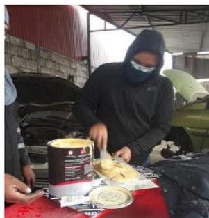
*Nota.* En la siguiente figura se puede observar el proceso de la aplicación de la masilla. Obtenido de (Pardo, 2022)
