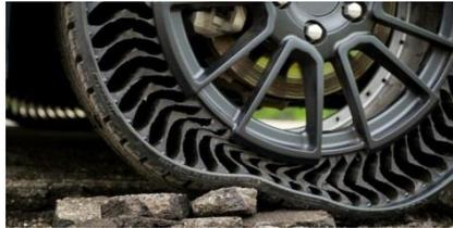
*Nota.* En la figura se puede observar un neumático compuesto con fibra de vidrio. Tomado de (Autocasion, s.f.)
