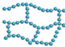
*Nota.* En la figura se puede observar la estructura de los elastómeros. Tomado de (Adhesivos, s.f.)
