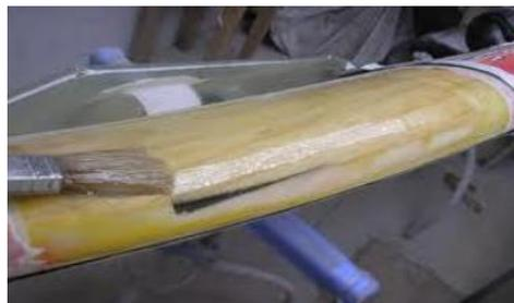
*Nota:* En la siguiente figura se puede observar el proceso moldeo con bolsa al vacío. Obtenido de (UIDE)
