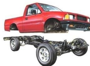
*Nota.* En la figura se puede observar el chasis independiente del automóvil. Tomado de (Ingemecanica, s.f.)
