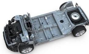
*Nota.* En la figura se puede observar la plataforma con carrocería separada del automóvil. Tomado de (SlidePlayer, s.f.)
