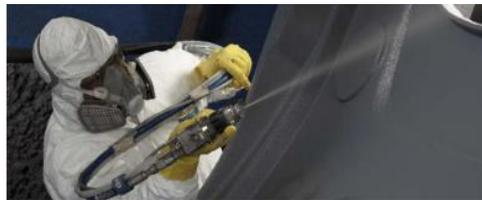
*Nota.* En la siguiente figura se puede observar el proceso de moldeo por contacto a inyección. Obtenido de (UIDE)
