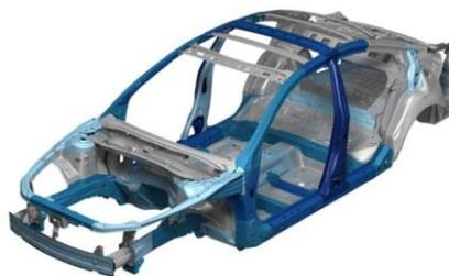
*Nota.* En la figura se puede observar la carrocería monocasco del automóvil. Tomado de (Prueba de ruta, s.f.)
