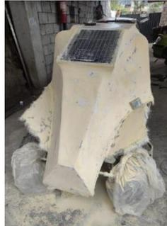
*Nota.* En la siguiente figura se puede observar el acabado con la capa de masillado
