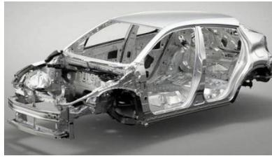
*Nota.* En la figura se puede observar la carrocería autoportante del automóvil. Tomado de (Motor.es, s.f.)
