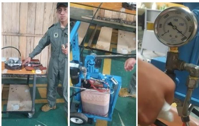
*Nota.* Representa prueba de fugas de hidráulico en la cámara de freno aplicando el equipo especial de la aeronave CASA CN 235 100/300 M.
