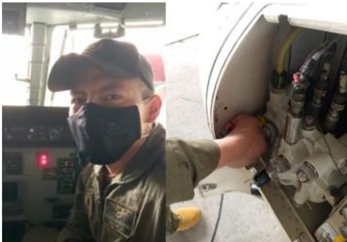
*Nota.* Representa la indicación de no operara las bombas en cabina y la despresurización de los acumuladores del sistema de la aeronave CASA CN 235 100/300 M.
