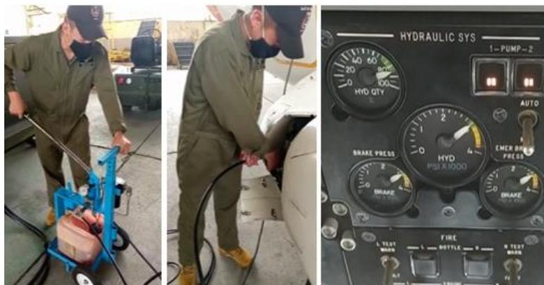
*Nota.* Representa el completamiento de fluido hidráulico en la Unidad Modular y el rendimiento del equipo especial de la aeronave CASA CN 235 100/300 M.
