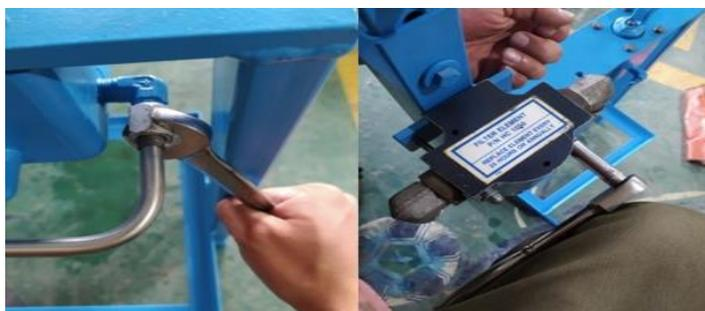
*Nota.* Representa la colocación de las válvulas en la bomba manual y colocación del filtro.
