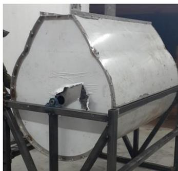
*Nota:* Cámara de sacudimiento apoyada sobre estructura de soporte.
