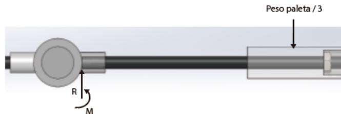
Nota: Vista frontal del eje roscado con sus fuerzas y reacciones.
