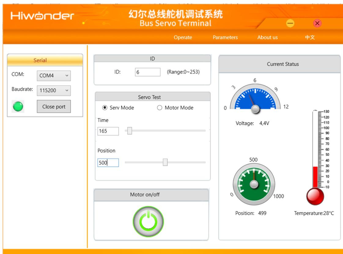
Se ingresa una posición de 500 pasos ( $120^\circ$  a  $0.24^\circ$  por paso) y se obtiene una rotación de 499 pasos, es decir,  $119.76^\circ$ . Se realizaron 10 experimentos con tres repeticiones en diferentes ángulos obteniendo los resultados de la Tabla 35.
