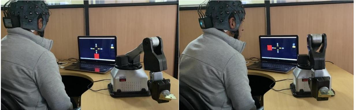
Cabe resaltar que en algunos casos el brazo robótico formó el cuadro sin errores; sin embargo, se mostró como ejemplo este caso para observar el proceso necesario para compensar un error, como se observa, por cada comando identificado incorrectamente se requiere un comando adicional para rectificarlo y regresar a la posición anterior.
