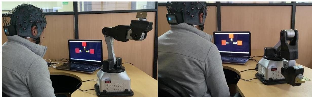
Luego, como se observa en la Figura 113, se identificó correctamente el comando “Subir”; sin embargo, en el siguiente comando “Derecha” se detectó un falso positivo del comando “Subir”.
