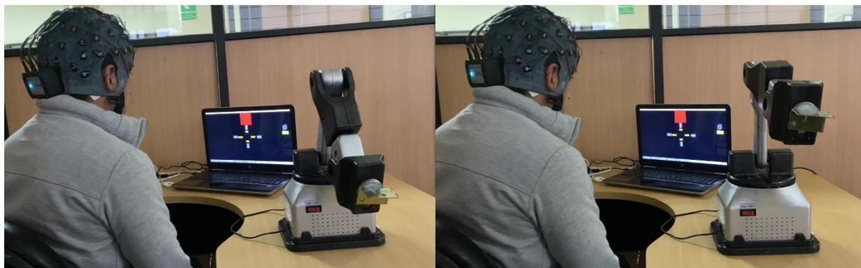
En la Figura 114, se observa como con una instrucción de “Bajar” identificada correctamente el brazo robótico se ubica en la posición anterior para continuar con su objetivo de formar un cuadrado y se detecta correctamente la instrucción “Derecha”.
