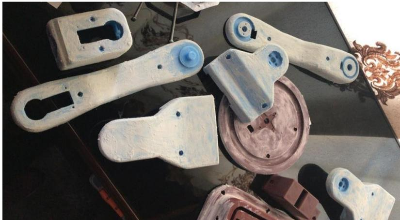
**Lijado.** Permite ir alisando la superficie previamente masillada para mejorar su acabado superficial (Figura 61). Se requiere empezar con lijas de grano grueso y terminar con lijas de grano fino, se emplearon lijas de grano 120, 240, 360 y 500.
