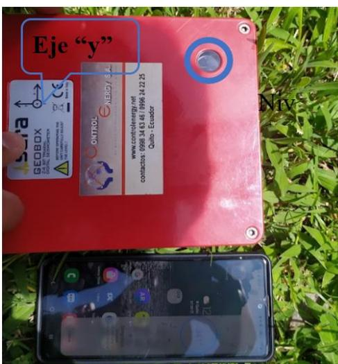
Se conecta el cable a un computador y mediante el software SEISMOWIN se empieza a registrar las señales. Para este proyecto se tomó la lectura en un tiempo estimado de 600 segundo debido a que el ruido ambiental no era excesivo (Ver Figura 60).
