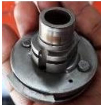
*Nota.* En la figura se observa la inspección del acoplamiento de impulso de los magnetos.
