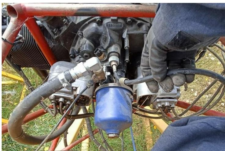
*Nota.* La imagen muestra la inspección preliminar que se realizó a los magnetos para verificar su condición.
