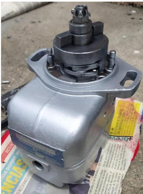
*Nota.* En la figura se observa el recubrimiento aplicado a los magnetos.
