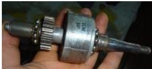
*Nota.* En la figura se observa la inspección del rotor del magneto de los magnetos.
