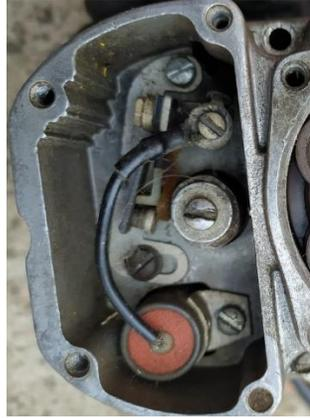
*Nota.* En la figura se observa la inspección de los puntos de contacto de los magnetos.
