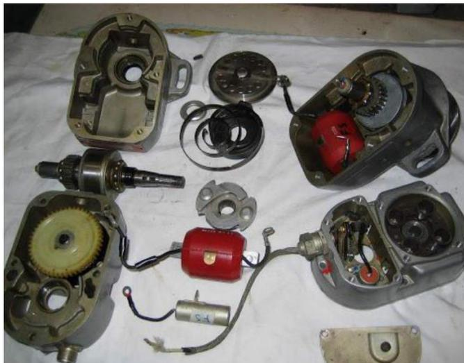
*Nota.* En la figura se observa los componentes internos de los magnetos del motor Lycoming O-540-A4E5.
