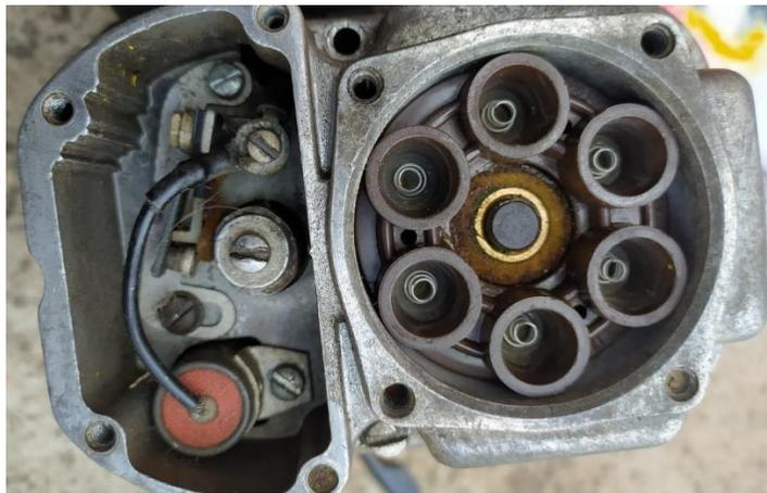
*Nota.* En la figura se observa la inspección del bloque distribuidor de los magnetos.
