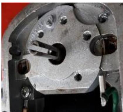
*Nota.* En la figura se observa la inspección del cojinete de bolas de los magnetos.
