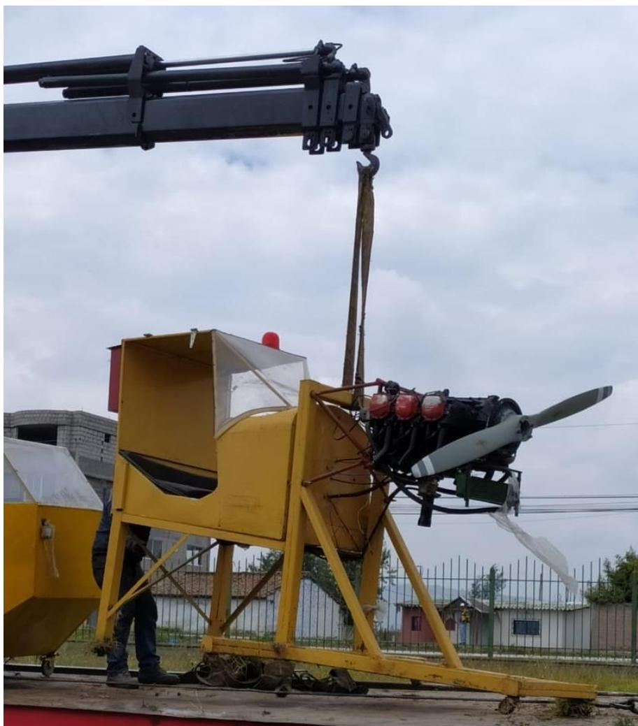
*Nota.* En la figura se observa el traslado del motor hacia un lugar donde se pueda realizar un mantenimiento adecuado.
