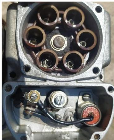
*Nota.* En la figura se observa la inspección del condensador de los magnetos.
