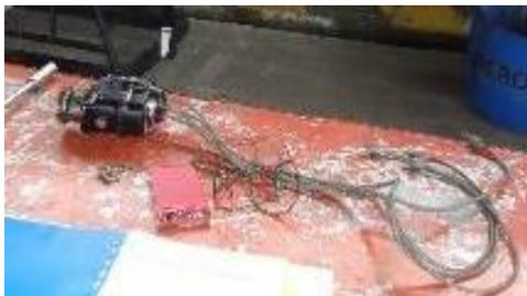
*Nota.* En la figura se observa la conexión del arnés de ignición al magneto.
