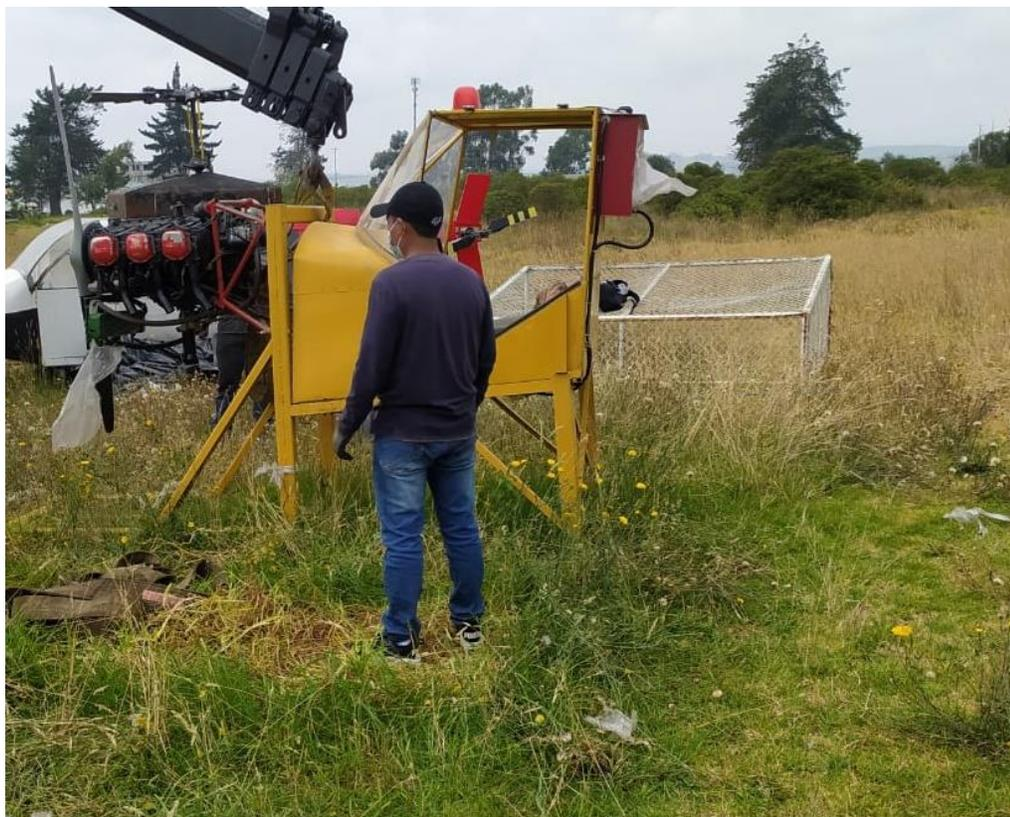
*Nota.* En la figura se observa la inspección preliminar que se realizó al motor, encontrando diferentes anomalías principalmente corrosión.
