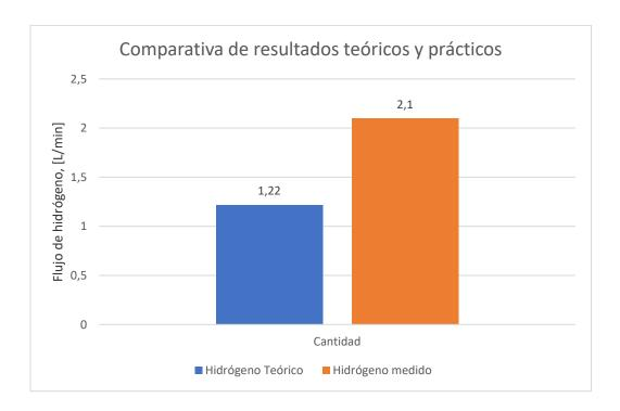
Nota. La cantidad de flujo teórico de hidrógeno es menor debido a que no se tiene una referencia exacta de todos los factores y entorno donde trabaja el generador.
