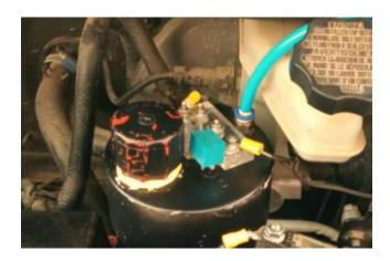
Nota. Espacio necesario en la parte superior del burbujeador para la tapa superior, módulo de medición de nivel de electrolito y manguera de salida de hidrógeno.
