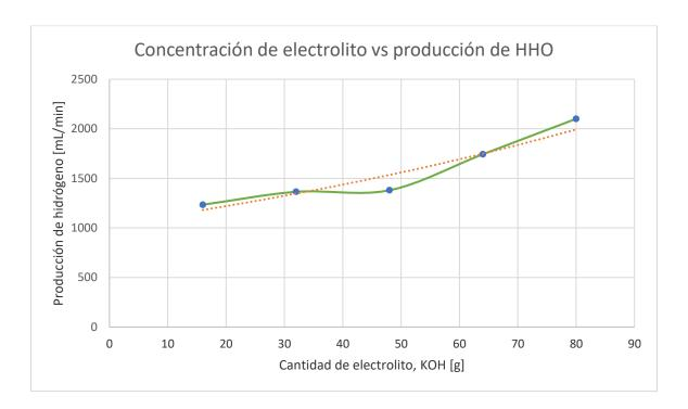
Nota. Mientras mayor sea la cantidad de la concentración de electrolito y agua destilada mayor va a ser la generación de hidrógeno, tomando en cuenta que no se debe exceder para no afectar la vida útil de las placas del mismo.
