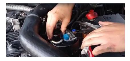
Nota. Se indica la ubicación en donde se monta el burbujeador/depósito, sujetado firmemente a la sabe metálica hecha a la medida.
