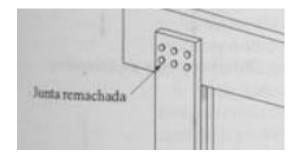
Nota. Las conexiones remachadas dependen de los denominados remaches, que debe tener un orificio preestablecido para la colocación del mismo. Tomado de Mott (1996).
