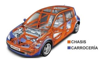
Nota. Disposición de la estructura: chasis y bastidor del vehículo. Tomado de Palomino (2017).
