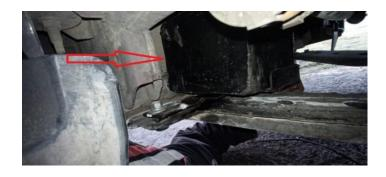
Nota. Se indica el montaje del generador de hidrógeno en su base metálica.
