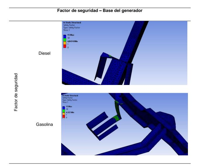
El factor de seguridad determina una falla, es decir, que el material se fracture, deforme, entre otras condiciones. Para el caso del vehículo diésel, el factor de seguridad de las bases del generador de hidrógeno es de 4,84 y en el caso del vehículo gasolina es de 4,32 que están
