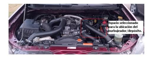
Nota. Se indica la ubicación establecida para la instalación del burbujeador/depósito y sus respectivas entradas de mangueras.
