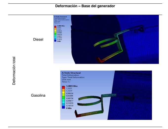
La deformación en la base del burbujeador del vehículo diésel, es la misma que en el vehículo gasolina, ya que al estar colocada en una misma posición y con una fijación en el motor, esta tiende a generar unas pequeñas vibraciones, sin embargo, dichas vibraciones no repercuten en el funcionamiento del mismo. La deformación total de la base es de 1,4885 mm no es mucha a comparación de la base del generador, esta soporta un menor peso, únicamente del generador y su contenido de electrolito.
