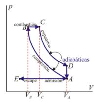
Nota. El ciclo termodinámico del motor diésel no se ve afectado debido a que se efectúa a presión constante, por lo que no varía ningún ciclo. Tomado de Rafael Morales & Guzmán (2014).
