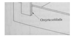
Nota. Las conexiones fijas, son de manera permanente, se debe tomar en cuenta que si se requiere su separación estas deben ser dañadas o fracturadas, perdiendo propiedades de los materiales. Tomado de Mott (1996).
