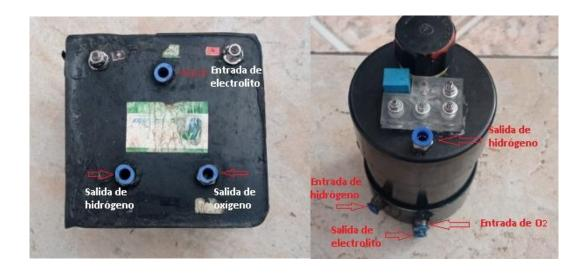
Nota. Se muestra la colocación de las mangueras en el burbujeador/depósito sujetadas por los acoples rápidos de 8mm tipo neumático.
