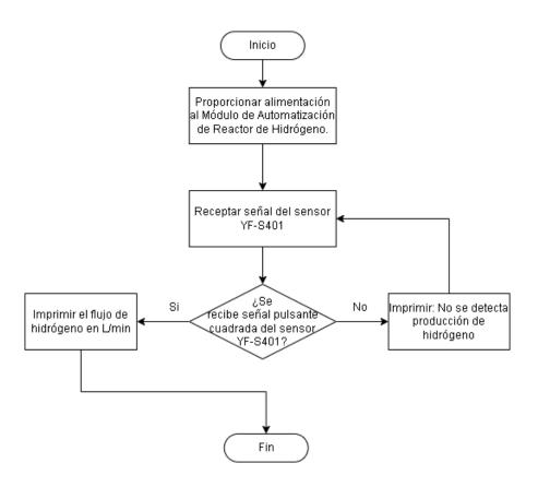
Nota. Se define la correcta lógica para la medición de flujo de hidrógeno.
