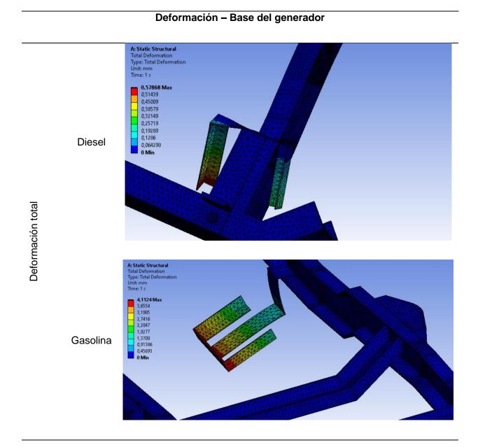
La deformación máxima que se produce en las bases del generador de hidrógeno en el vehículo gasolina es de 4,1124 mm debido a que esta no tiene una estructura de soporte para el peso del generador, en el caso del vehículo diésel tiene una deformación máxima de 0,5786
