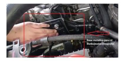
Nota. Se especifica la ubicación donde fue montada la base metálica para el burbujeador/Depósito.
