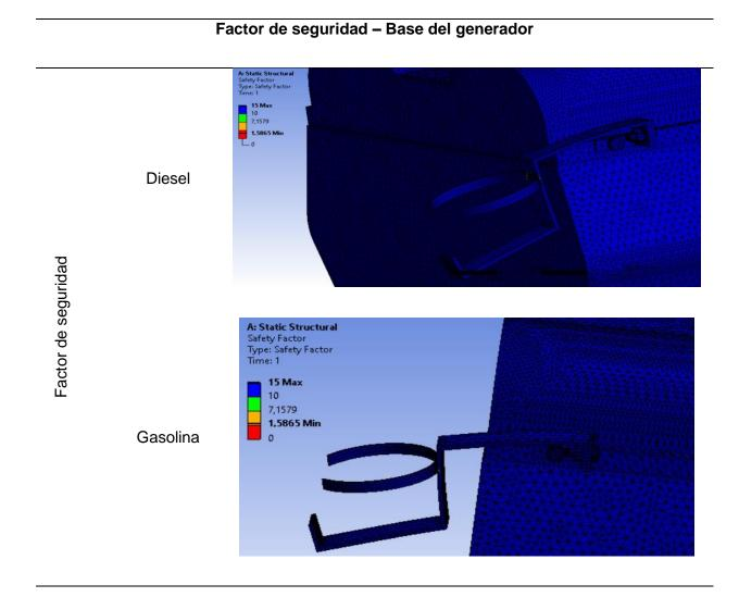
El factor de seguridad para la base del generador en el vehículo diésel, y en el vehículo gasolina son las mismas debido a la posición y el método de fijación con el que están montados, por ende, se tiene un factor de seguridad de 7,15 siendo este un valor muy aceptable debido a que este tipo de base ni soporta mayor carga del burbujeador, incluso siendo está un poco más alta que la recomendada en el diseño ingenieril. Pero este factor de seguridad determina cuan seguro es este diseño.
