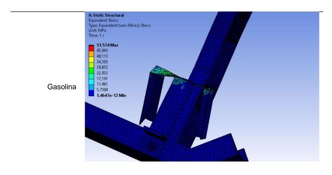
En el caso del estrés equivalente en las bases de soporte del generador de hidrógeno, al estar suspendidas y no tener un punto de apoyo en la base del mismo en el caso del vehículo a gasolina.
