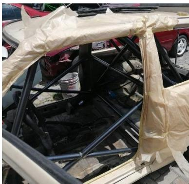
*Nota.* Preparación del vehículo para pintar su estructura de seguridad.
