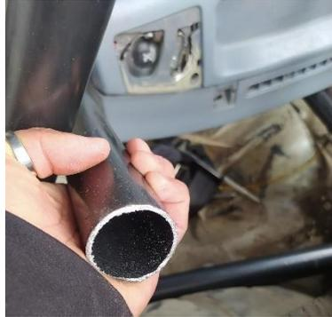
*Nota.* Se corte es realizado primero por una sierra de mano y la toma para su acople con otro tubo es definido por un proceso de aserrado por disco.
