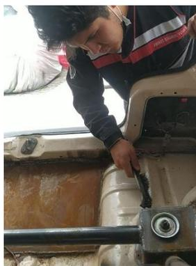
*Nota.* Para la limpieza de los hilos de soldadura se utilizó papel de lija y un cepillo de alambre.
