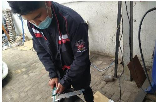
*Nota.* Para el marcaje se lleva a cabo tanto en el perfil tubular como en la platina que servirá como refuerzo para la base.
