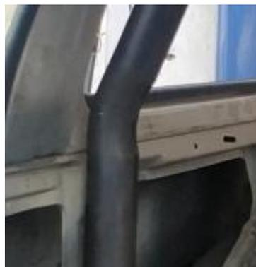
*Nota.* Se realizan los dobleces necesarios en los perfiles tubulares para obtener la forma deseada para la construcción.
