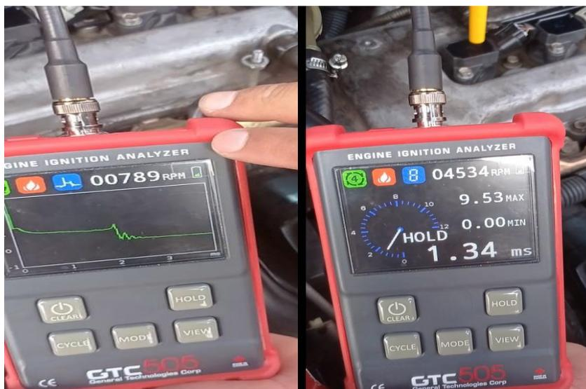
*Nota.* En la figura se puede observar en la parte izquierda la medición de las RPM del motor y en lado derecho como se visualizan los datos de la prueba después de la realización de la descarbonización en los vehículos de ensayo 1 y 2.
