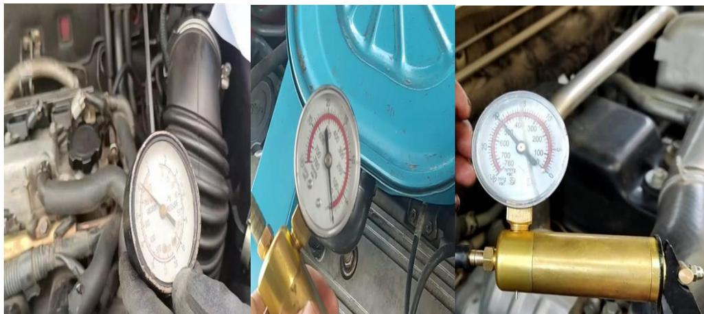
*Nota.* En la figura se puede visualizar algunos de los valores obtenidos en la realización de las medicaciones en la prueba de vacío en los vehículos de ensayo.
