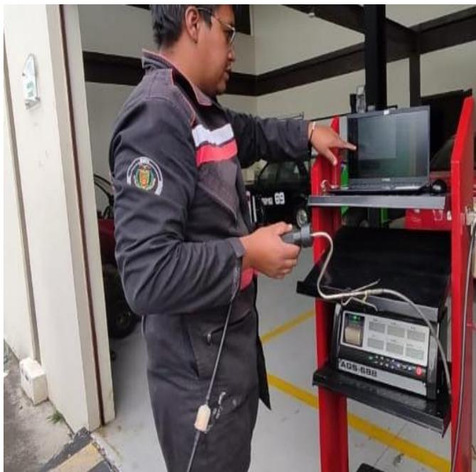
*Nota.* En la figura se puede observar el analizador de gases AGS-688 y la sonda con su respectivo filtro, empleada en el proceso de medición de las emisiones en los vehículos de prueba.
