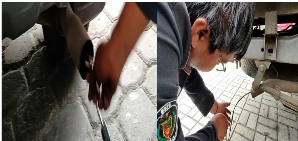
*Nota.* En la figura se puede observar la introducción de la sonda en el sistema de escape para la recolección de datos después del proceso de descarbonización.
