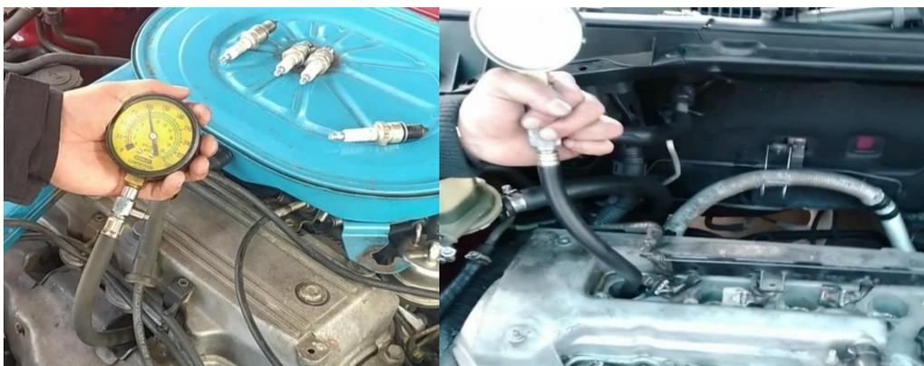
*Nota.* En la figura se puede observar el compresómetro colocado en los cilindros de los vehículos de ensayo para posteriormente medir su compresión.
