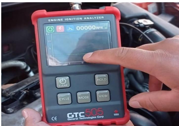
*Nota.* En la figura se observa el equipo GTC 505 empleado en las pruebas de los vehículos de ensayo 1 y 2.
