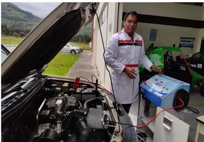
*Nota.* En la figura se observan las conexiones de alimentación y de colocación en el sistema de admisión del equipo de descarbonización en el vehículo de ensayo, en las instalaciones del laboratorio de Autotrónica.
