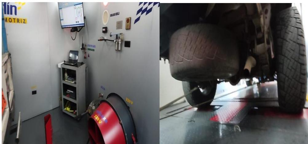
*Nota.* En la figura se observa los componentes del dinamómetro de rodillos Sáenz BPVI empleado en las mediciones de Torque – Potencia de los distintos vehículos de ensayo.
