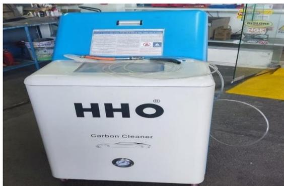
*Nota.* En la figura se visualizar el equipo utilizado en la descarbonización de motores por el Taller de reparación de automóviles SERVICENTRO de ciudad de Quito.
