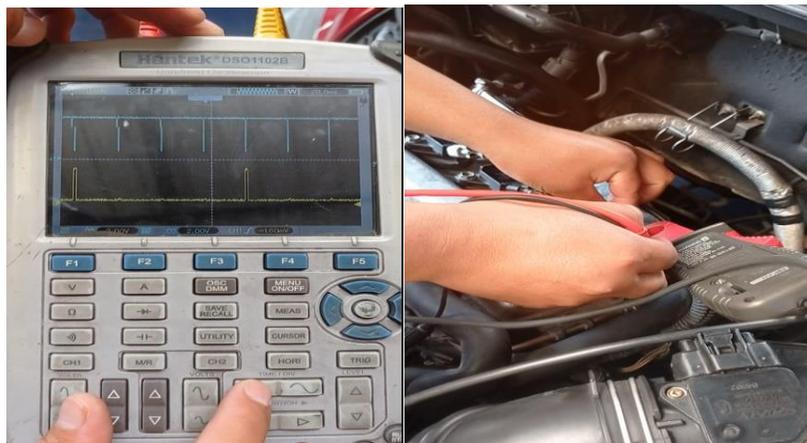
*Nota.* En la figura se puede observar la utilización del osciloscopio y las pinzas amperimétricas para la realización de las mediciones.
