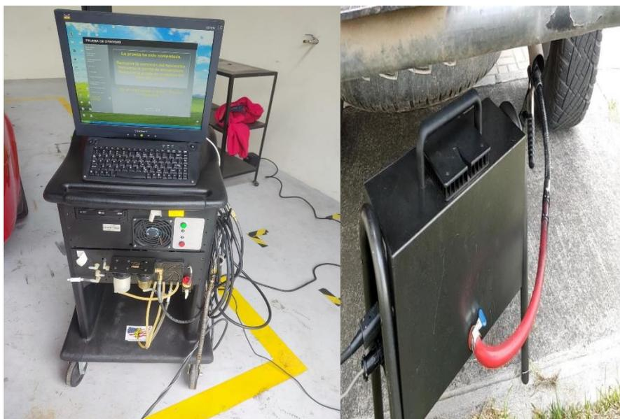
*Nota.* En la figura se observa el equipo y el opacómetro entregado por el laboratorio de Autotrónica para el desarrollo de la investigación.
