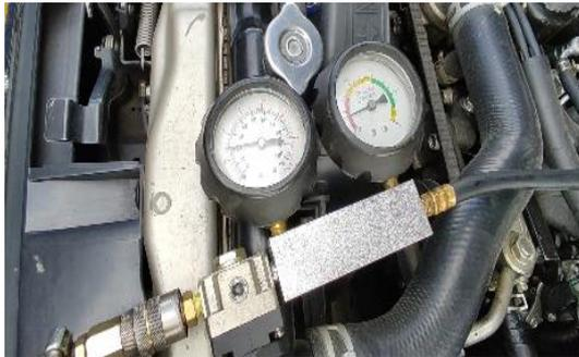
**Medidor de fugas de cilindros**
