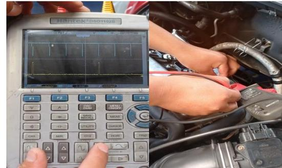
**Osciloscopio y pinza Amperimétrica**
