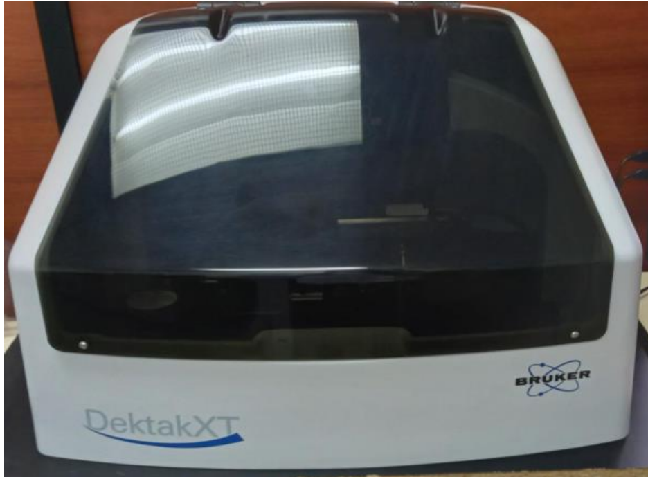
Figura 20: Perfilómetro Bruker, modelo Dektak XT, usado para medir la rugosidad en las probetas pavonadas
