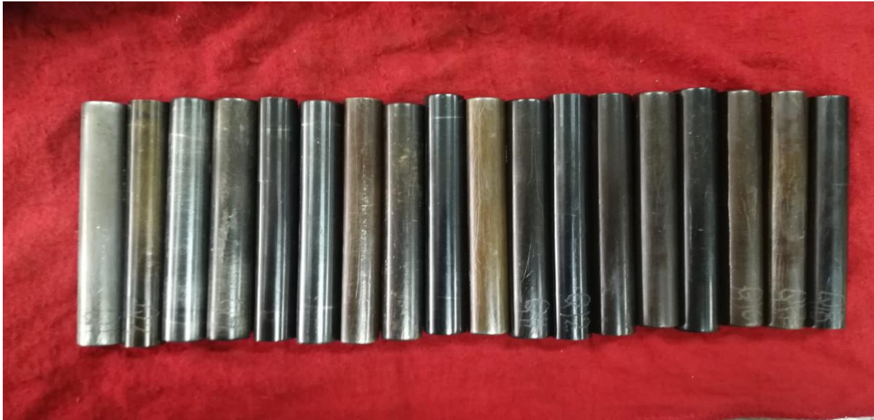
Figura 4: Distintas tonalidades de tono oscuro del acero obtenidas mediante el proceso de pavonado químico con distintos tiempos de sumersión y cantidad de agente químico
