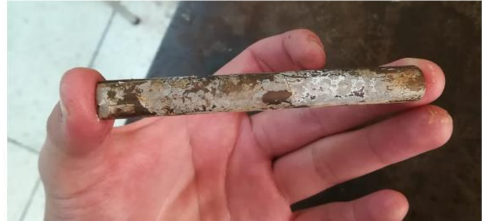
Figura 70: Probeta completamente oxidada al no limpiar el agente químico después de aplicar el pavonado
