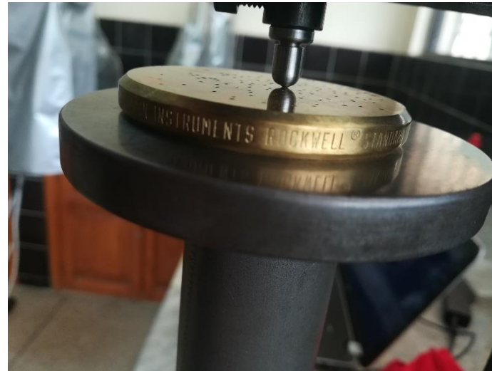
Figura 8: Calibración del durómetro con el patrón HBR 88
