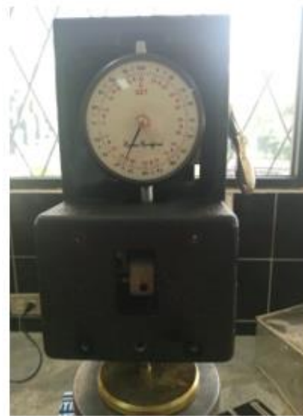
Figura 18: Calibración del durómetro con el patrón HBR 88
