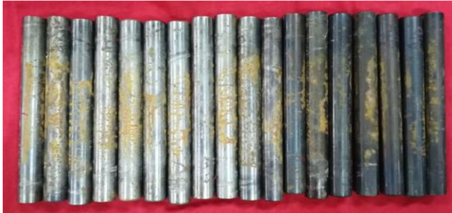
Figura 58: Probetas oxidadas después del ensayo de inmersión alternada
