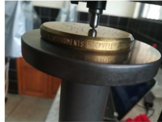
Figura 18: Calibración del durómetro con el patrón HBR 88
