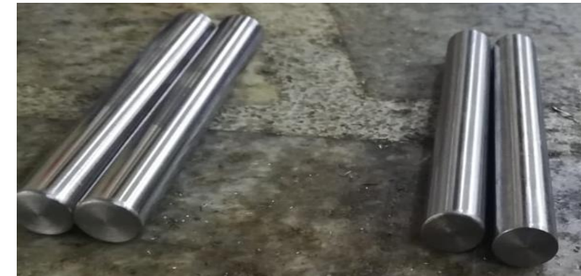
Figura 14: Probetas de ensayo con acabado superficial tipo pulido dado por lija y piedra de rectificar
