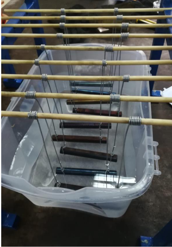
Figura 23: Zona de trabajo de la prueba de resistencia a la corrosión
