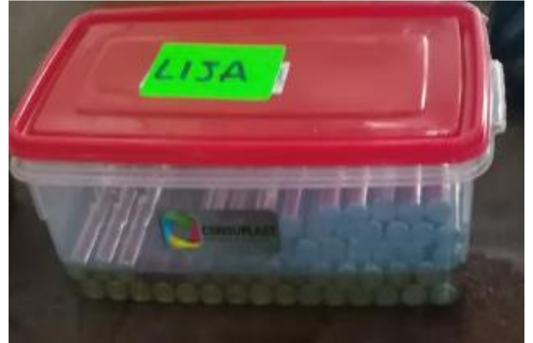
Figura 16: Probetas con acabado superficial del tipo "lijado" almacenadas en aceite 20w-50
