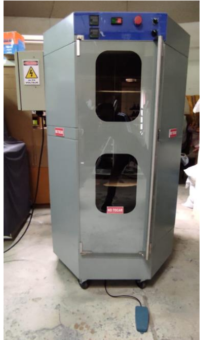
Sistema automático de secado y reactivado de suela y capellada del calzado CIARA
