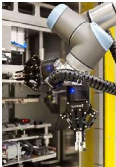
*Nota.* Pinzas paralelas servoeléctricas duales de la empresa Universal Robots usadas para la manipulación de placas de circuito impreso. Tomado de (UNIVERSAL ROBOTS, 2019)
