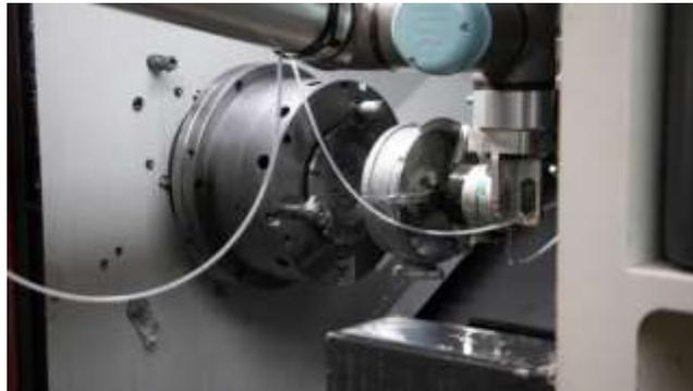
*Nota.* Pinza Pneu-Connect de tres mordazas utilizada en la empresa RCM Industries. Tomado de (UNIVERSAL ROBOTS, 2019)
