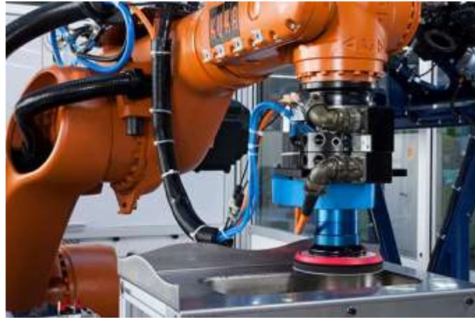
*Nota.* Herramienta de desbaste marca Suhner acoplado a un robot KUKA. Tomado de (Carvajal, 2018)
