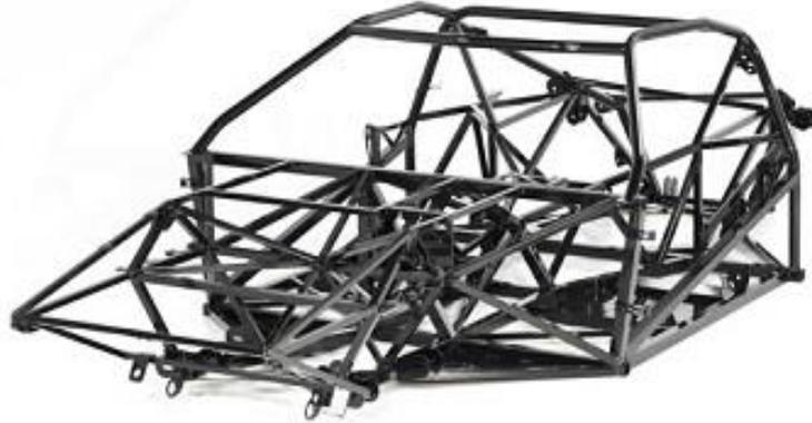
*Nota.* Modelado de un bastidor tubular y su forma. Tomado de (Autocrash, 2017, Marzo 14)
