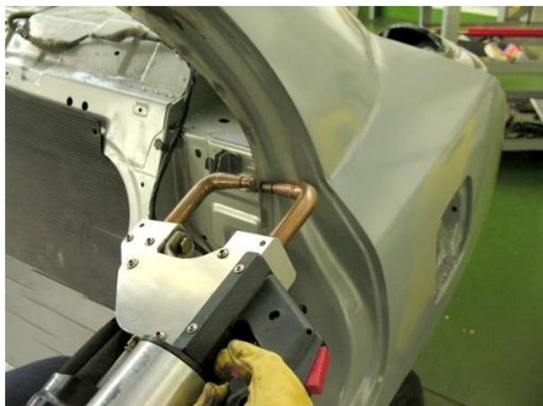
*Nota.* Se visualiza el proceso de soldadura por puntos de resistencia. Tomado de (Mecánica de materiales, 2015)
