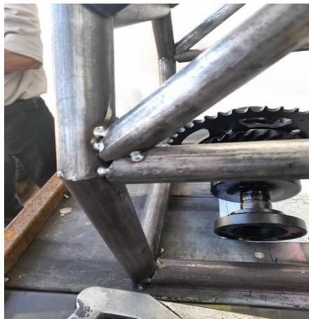
*Nota.* Para unir los tubos se utiliza la técnica de suelda por puntos.
