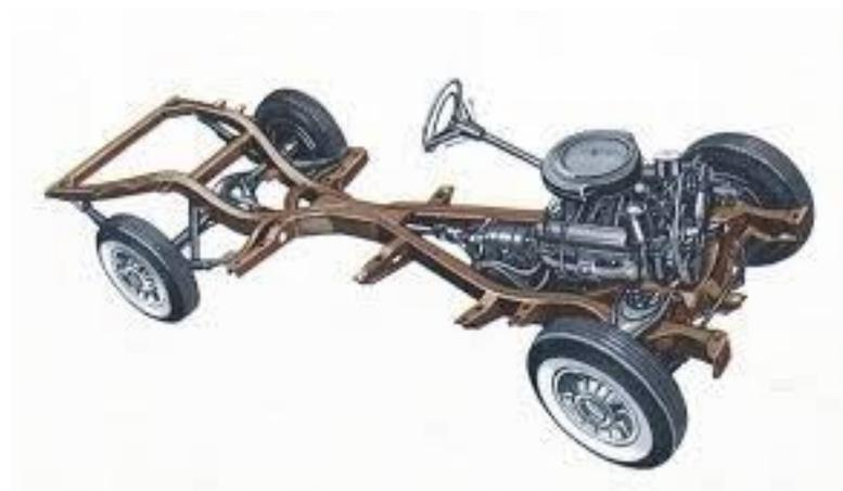
*Nota.* Modelado de un bastidor de tipo columna o en x. Tomado de (Euroweld, 2020)
