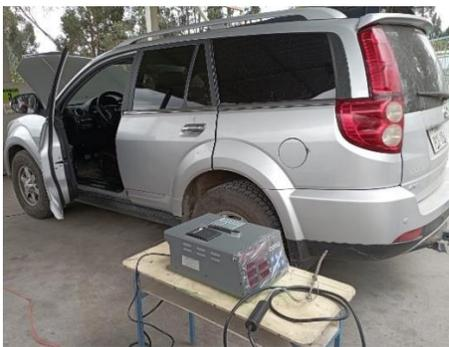
*Nota.* Vehículo Great Wall H5 2015 preparado para realizar pruebas de emisiones de gases antes del proceso de descarbonización.
