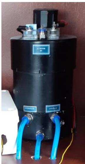
*Nota.* Construcción del módulo electrolito del equipo descarbonizador.
