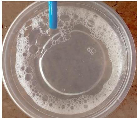
*Nota.* En la figura se muestra la solución jabonosa donde se realiza la prueba de la generación de HHO.
