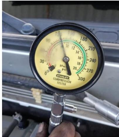
*Nota.* En la imagen se presenta un compresómetro de la marca Stanley, se observa una lectura de un valor de 120 PSI de presión de compresión en el segundo cilindro.
