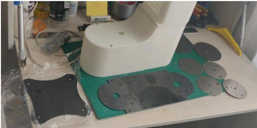
Para que el mecanismo del brazo evite deflexiones en el eje utilizado se confecciona una estructura a modo de soporte para el eje, utilizando una platina de acero estructural de 4mm de espesor y 35mm de ancho, que se muestra en la Figura 157.
