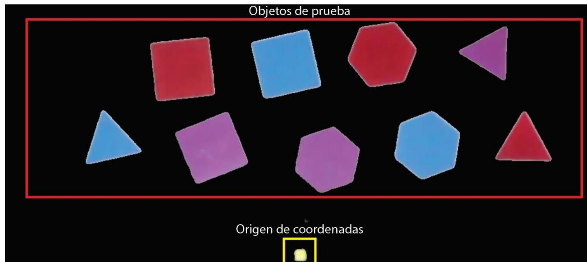
En el algoritmo de detección de forma y color se obtiene un vector con coordenadas de cada figura, mismo que se puede usar para calcular el centro de la figura y su posición en píxeles, por lo que se procede al cálculo de la distancia en píxeles desde el origen de coordenadas (forma color amarillo) hacia los objetos de prueba.
