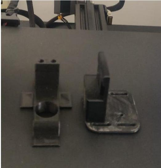
Para el eje del mecanismo del brazo se utilizaron chumaceras de instrumentación, que permiten que ingrese un eje de 12mm, mientras que para el eje del antebrazo se confeccionaron chumaceras en PLA, que permiten alojar rodamientos para ejes de 9mm. Estas chumaceras se muestran en la Figura 150.
