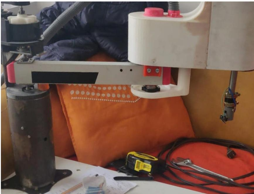
Al ensamblar las partes del mecanismo del brazo y antebrazo, la parte interna del antebrazo tiene la apariencia que se muestra en las Figuras 159 y 160. Ya cuenta con los soportes respectivos para el motor de este eslabón y los acoples necesarios para unirse al eje.
