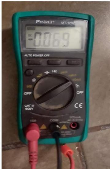
Se contrastaron las medidas obtenidas de la simulación con las obtenidas por medición mediante amperímetro en la Tabla 59, y se obtienen los resultados de error porcentual. Al reflejar errores menores al 5% se puede determinar que las conexiones realizadas son acordes al diagrama planteado, y no existen fugas de corriente en el circuito electrónico implementado.
