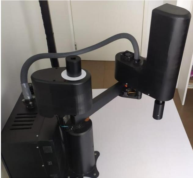
Para sostener la cámara web que se utiliza para el proceso de visión artificial se requiere de una estructura que permita apuntar hacia el espacio de trabajo del robot. Por lo que se construyó la estructura que se muestra en las Figuras 162 y 163, que permite regular en dos direcciones la posición de la cámara web. En esta misma estructura se coloca la estructura de los indicadores LED del estado del robot.
