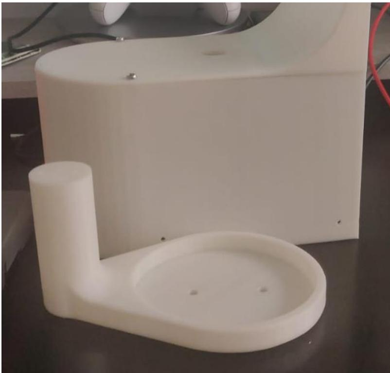
Una vez confeccionadas todas las piezas, se puede apreciar la apariencia de la estructura de cubierta del antebrazo, que posteriormente fue rectificada por desperfectos provocados por la impresión, y cubierta de pintura negra mate. En la Figura 154 se muestra la estructura de cubierta del antebrazo completa antes del proceso de pintura.
