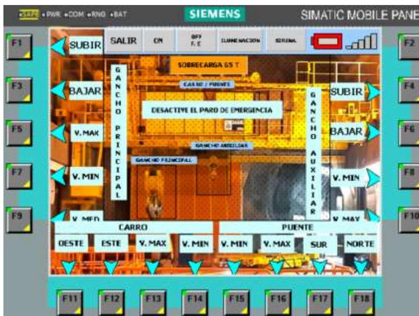
En la parte lateral izquierda se muestran los comandos para el control del gancho principal, estos se manejan por las teclas de funciones desde F1, F3, F5, F7, F9; el control del gancho auxiliar se maneja con las teclas F4, F6, F8, F10; para el control y manipulación del carro y puente se utilizan las teclas desde F11 a F18. En la parte superior se muestran los botones de navegación del sistema.
