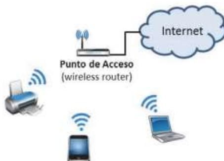
**Arquitectura de la red.** La estación: por lo general es una PC, sin embargo, con el avance tecnológico estas han sido reemplazadas por teléfonos, tables o cualquier dispositivo con capacidad de intervención en medio inalámbricos.
