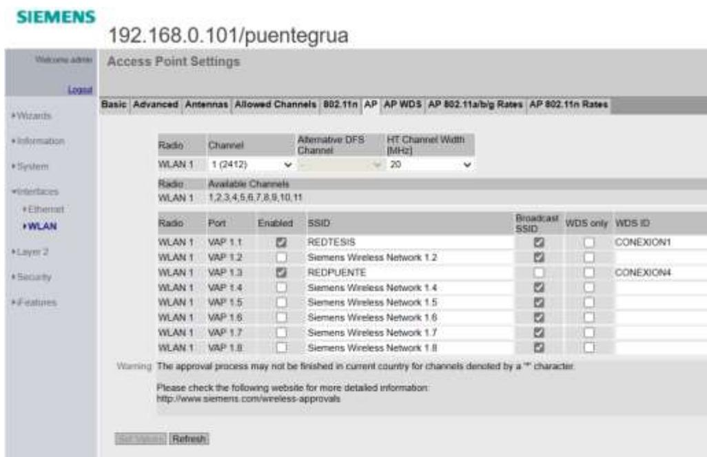
Para establecer la conexión entre los dos puntos de acceso se deberá configurar el Scalance101 y el scalance103 con los mismo datos de red y puerto para que la transferencia de datos sea posible, en la figura 78 se muestra que el puerto 1.1 esta activado, en este se carga el nombre de la red (REDTESIS), ahora para establecer este dispositivo como elemento de conexión con el scalance103 se dicta un nombre al WDS ID como “CONEXIÓN1”, esta configuración se hace en la ventana de AP del WEB MANAGMEN
