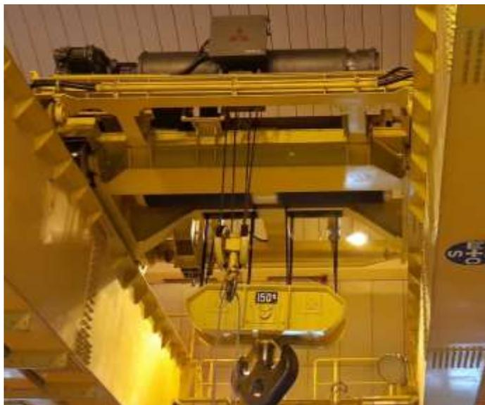
*Nota.* En la figura 4 se muestra el carro del puente grúa, este elemento permite los movimientos de este a oeste. Tomado de casa de máquinas de la central Agoyán.
