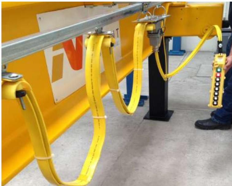
*Nota.* En la figura 6 se muestra la disposición del mando por botonera y el carrete dispuesto en una de las vigas del puente, en este caso el carrete cuenta con ruedas que a manera de riel se desplazan transversalmente por el puente grúa.
