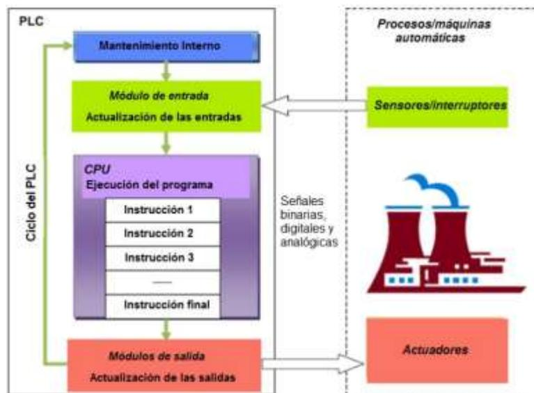
*Nota.* En la figura 9 se muestra el ciclo de funcionamiento de los PLCs, se debe cumplir condiciones para el arranque e inicio del programa, lectura de datos de entrada, ejecución del programa y actualización de salidas.
