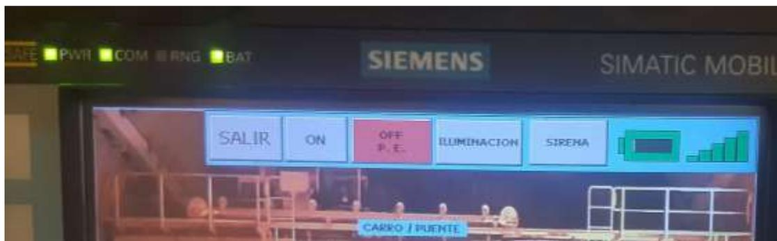
También en la figura 87 se muestra el estado de conexión del panel, el panel mobile 277 IWLAN posee leds indicadores que evidencian si el panel se encuentra en condiciones para su uso, el led PWR, muestra que el nivel de carga de la batería es el adecuado para la operación.
