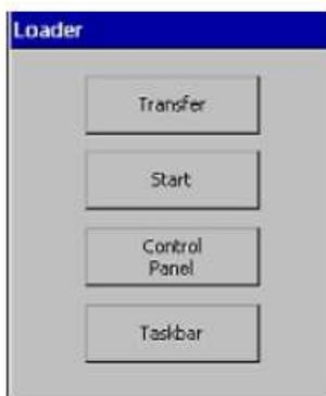
El botón "Transfer" conmuta el panel operador a un modo de transferencia de datos, solo se activa si esta al menos un canal de transferencia de datos.
