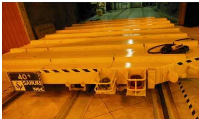
Su diseño compacto y control de movimiento, permite la manipulación del transportador, sin embargo, el mando cableado no permite el libre tránsito del operador para verificar que las cargas transportadas causen daños a externos.
