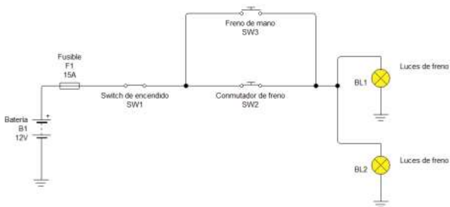
Circuito luces de freno
